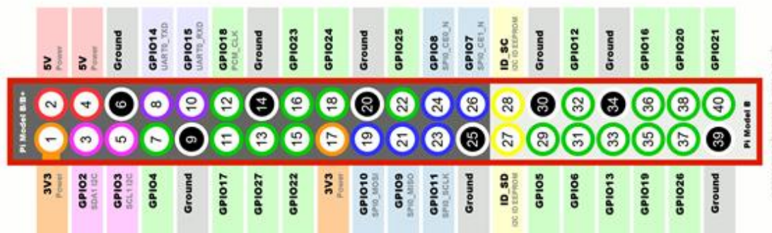
Kuva 5. Raspberry Pi 3 b Pinnien merkitykset.
