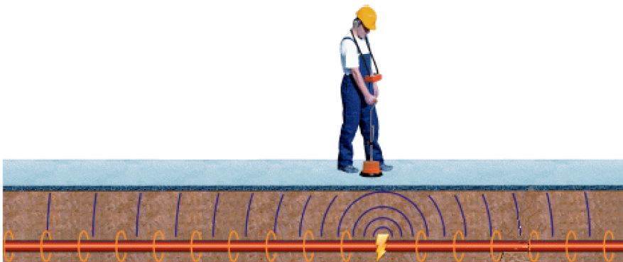
KUVA 4. Syöksyaaltomenetelmän periaate (Megger 2018.)
