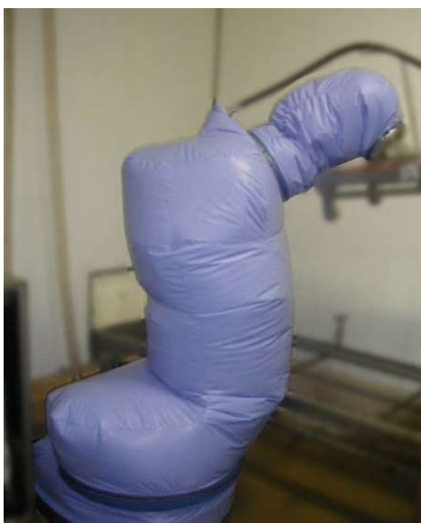
Kuva 15. Elintarviketeollisuuteen sopiva robotin suojapuku. (ASP 2010.)
