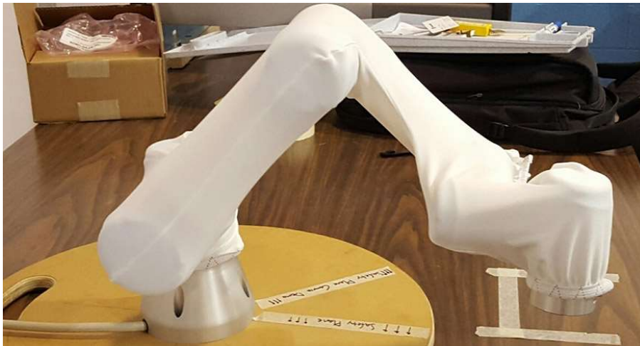
Kuva 14. Kertakäyttöinen puku maalausrobotille. (Robo-Gear n.d.)
