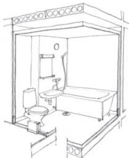
KUVA 10. Kevytrakenteinen kylpyhuone-elementti (ASUNTOJEN MÄRKÄTILOJEN KORJAUS. KORJAUSRAKENTAMINEN. RT 84-11093, 26.)
