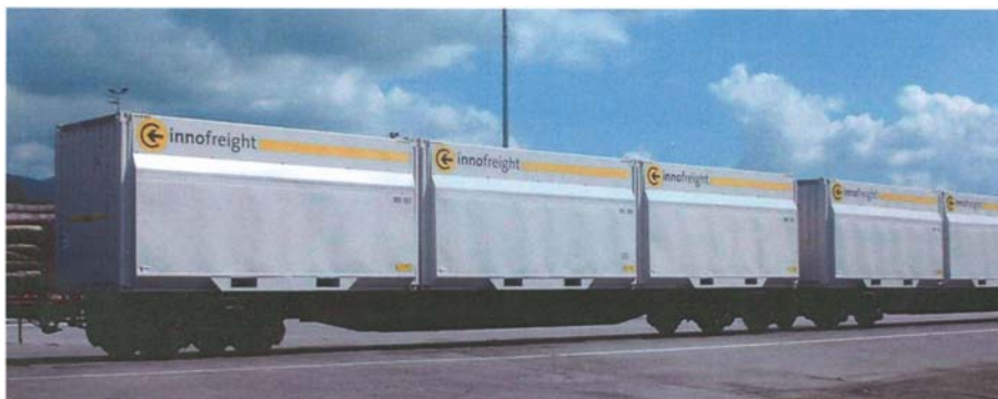
Kuva 4. Innofreight konttijärjestelmä, joka sopii sekä junavaunuihin että autoihin (Kuva: Innofreight-yhtiön esite "WoodTrainer XXL")
