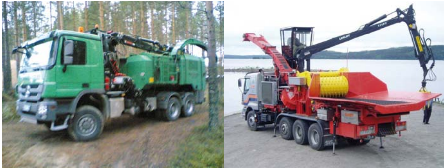
Kuva 1. Kuvassa vasemmalla Mercedes Benzin alustalle rakennettu hakkuri ja oikealla kotimainen Sisun alustalle rakennettu hakkuri (Kuvat: Hannu Lähdevaara (vas), Kotimaiset Energiat Oy (oik.))
