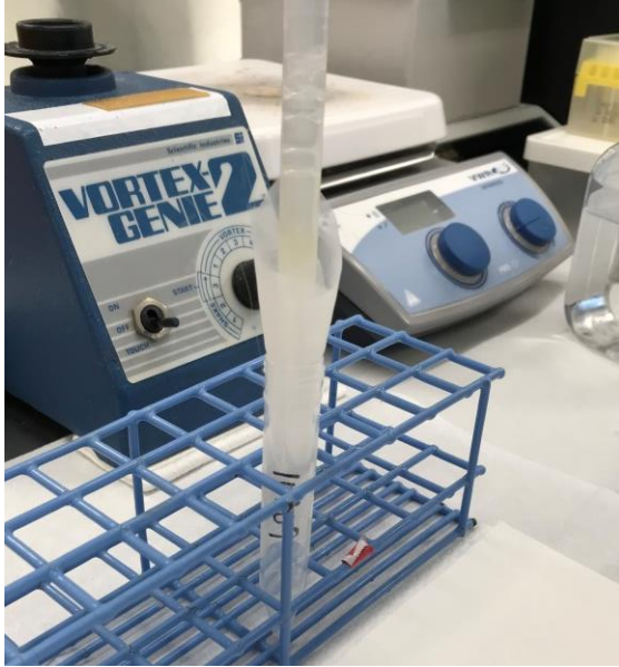
Kuva 3. Yskösnäytteen suodatus nailonverkon läpi.
