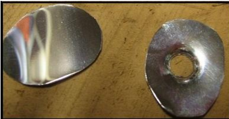
KUVA 28. Led-valojen takana olevat ”peilit”.
