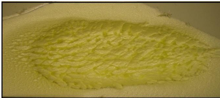
KUVA 30. Kuumailmapuhaltimella muokattua finnfoamia.
