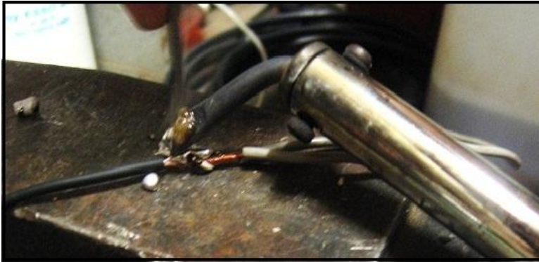
KUVA 26. Liitosjohdot tinataan kolvilla yhteen.
