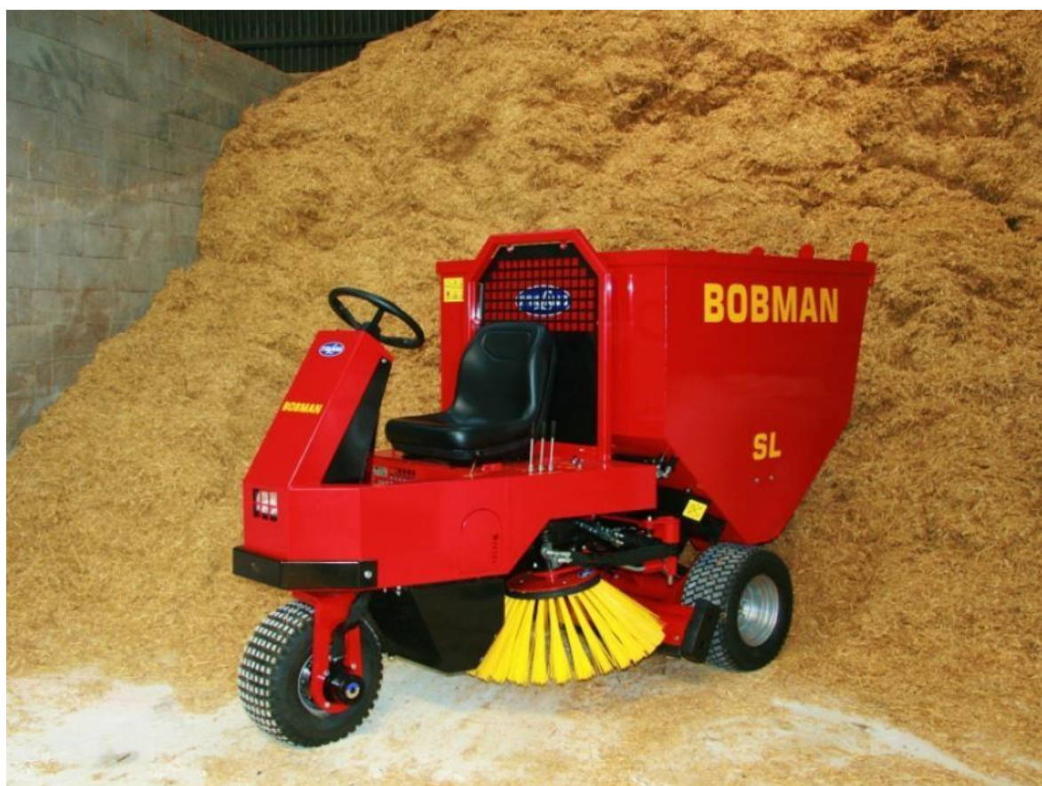
Kuva 5. Bobman SL itsestään kulkeva kuivituskone.
