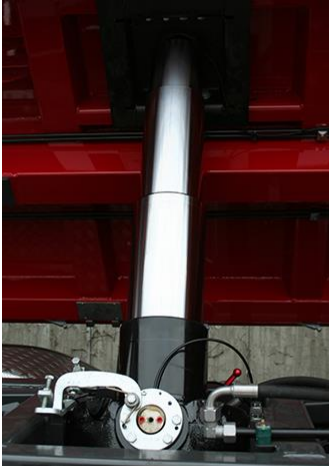
Kuva 1. Kuva teleskooppisynteristä asennettuna maansiirtoautoon
