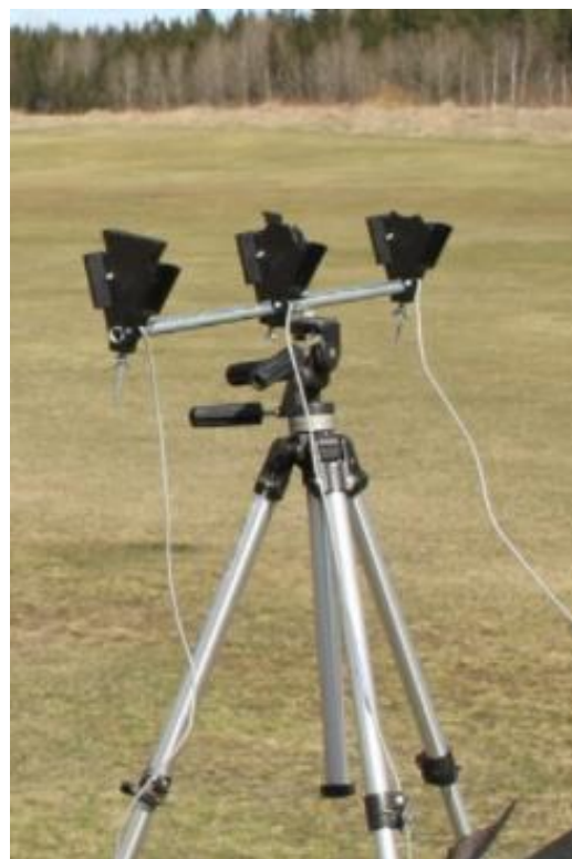
Figur 24 Skyscreen med tre optiska sensorer
