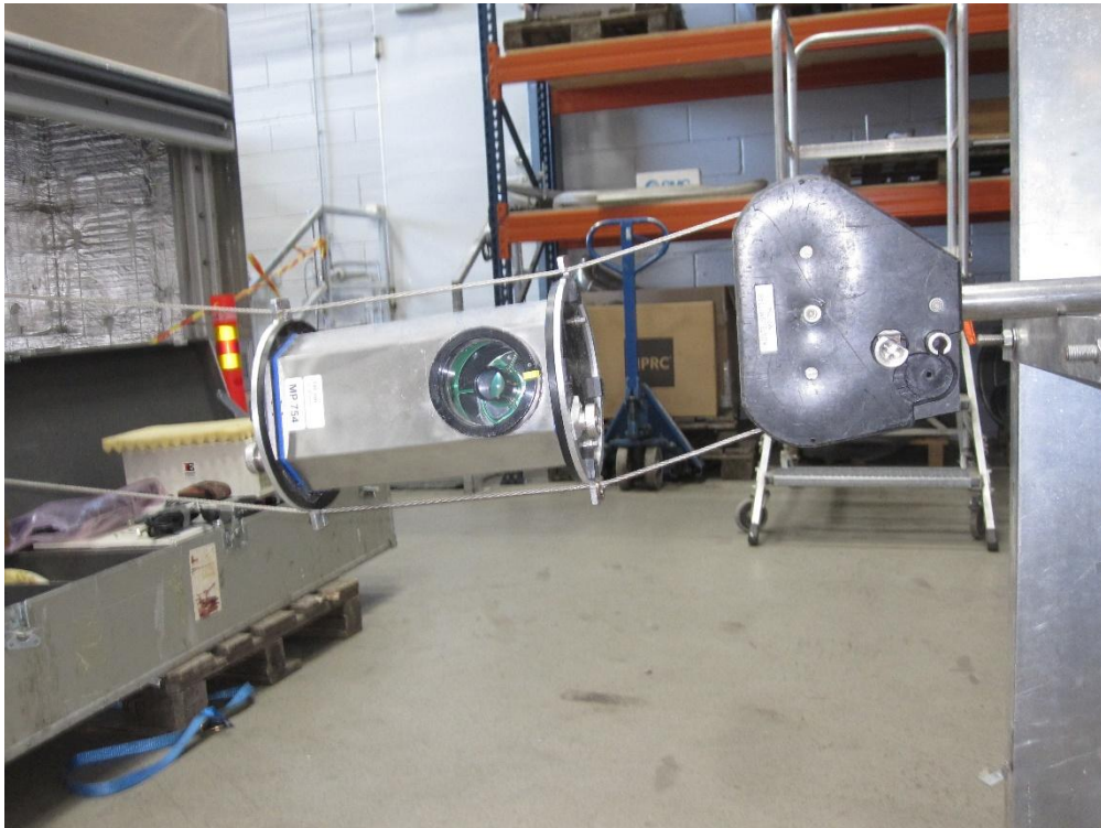
Kuvio 13. Kosteusmittari kiinnitettynä vaijeriin
