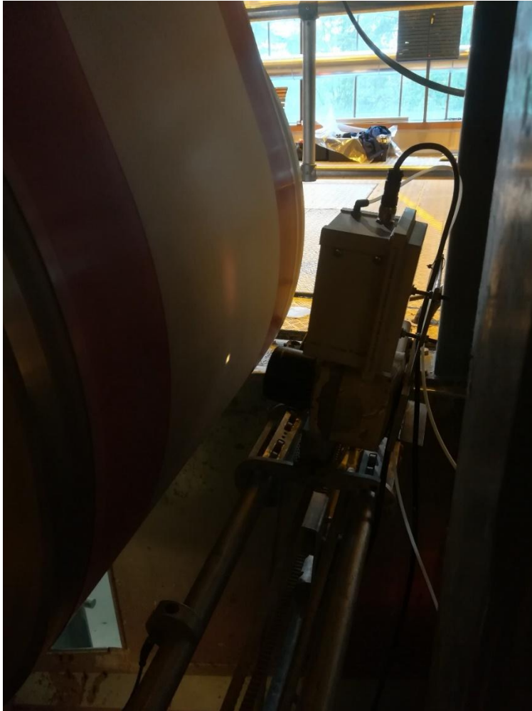
Kuvio 18. IRMA-7-mittarin asennus 185 mm etäisyydelle kartonkiradasta sekä kääntäminen pystyasentoon
