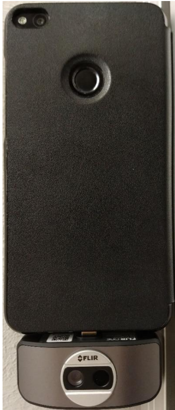
Kuvio 1. FLIR ONE kytkettynä älypuheliimeen
