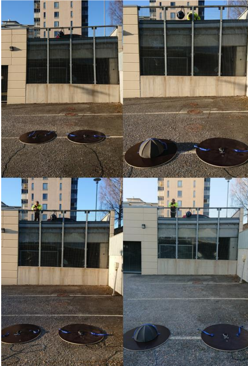
KUVA 8. Sekundäärituulisuojan ominaisuuksien määrittäminen mittauksilla. Vasemmalla suojan ominaisuuksien määrittämiseen käytetty mittari, oikealla referenssimittari
