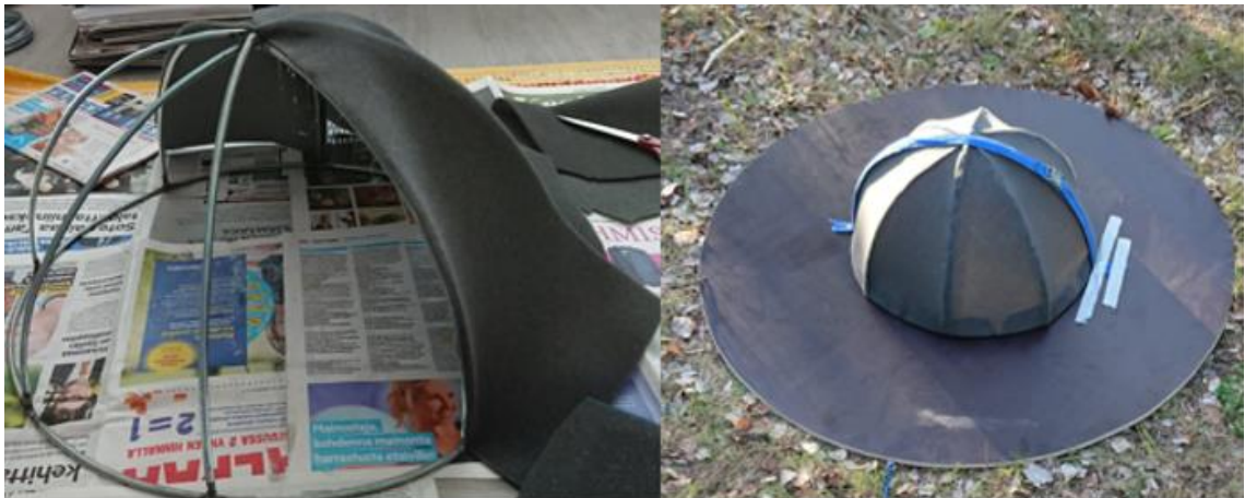
KUVA 7. Vasemmalla sekundäärituulisuojan metallirunko ja 3mm paksu avoimen solurakenteen vaahtomuovipäällyste ja oikealla sekundäärituulisuojan kiinnitys mittauslevyyn.
