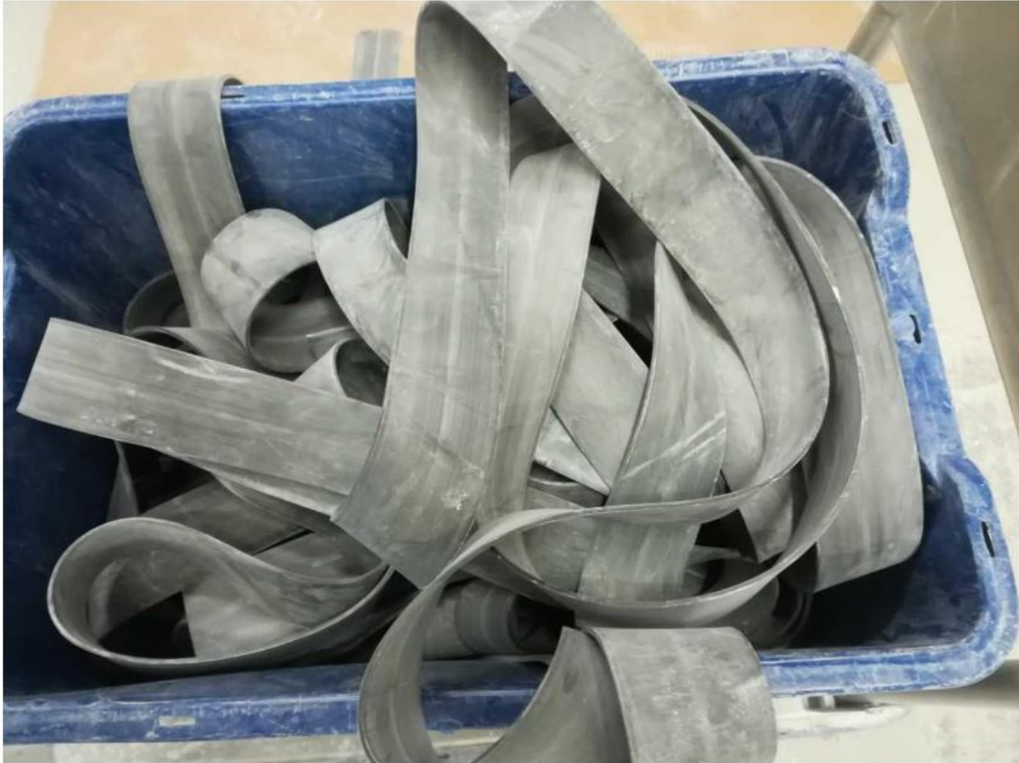
KUVA 5. Talkittu silikoniprofiili. Profiilin pinnalle on jäänyt irtainta talkkia
