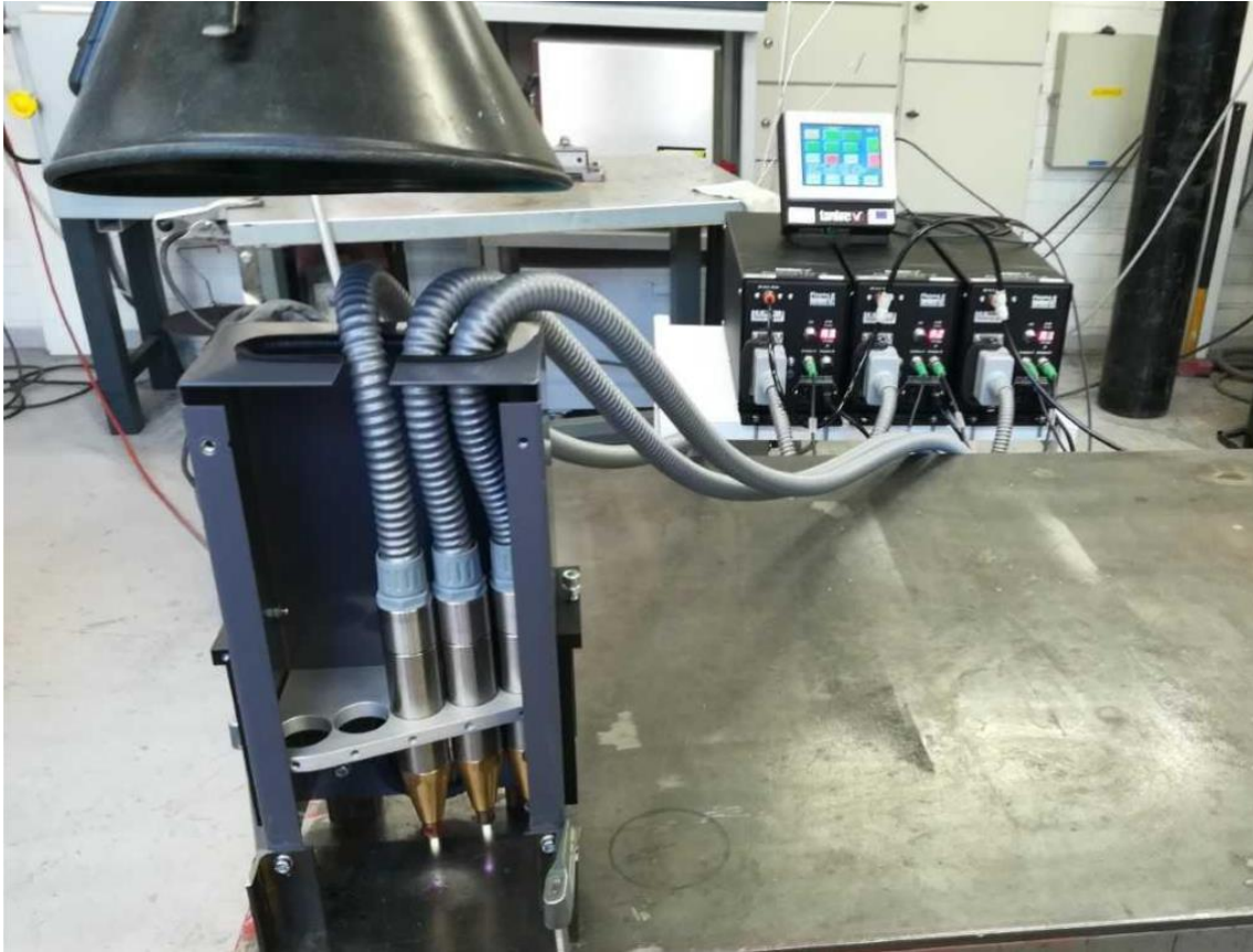
KUVA 3. Plasmalaitteisto käyttökunnossa. Plasmasuuttimet ovat kuvan etualalla
