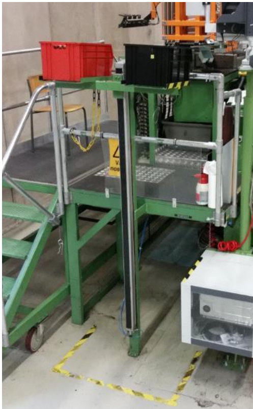
KUVA 16. Puolahissi vanhoilla laatikoilla (Kuva: Jaakko Kolstela 2017)
