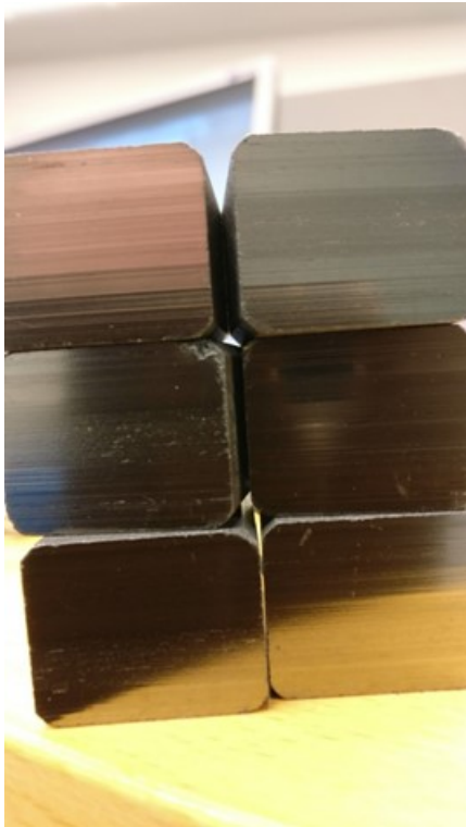
Kuva 10. Ossauskosken käytettyjä hiiliharjoja.
