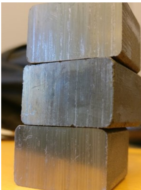
Kuva 9. Valajaskosken käytettyjä hiiliharjoja.
