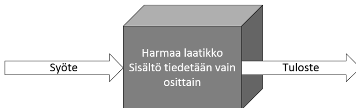
KUVA 5 Harmaa laatikko -testauksessa testattavan asian sisältö tiedetään vain osittain
