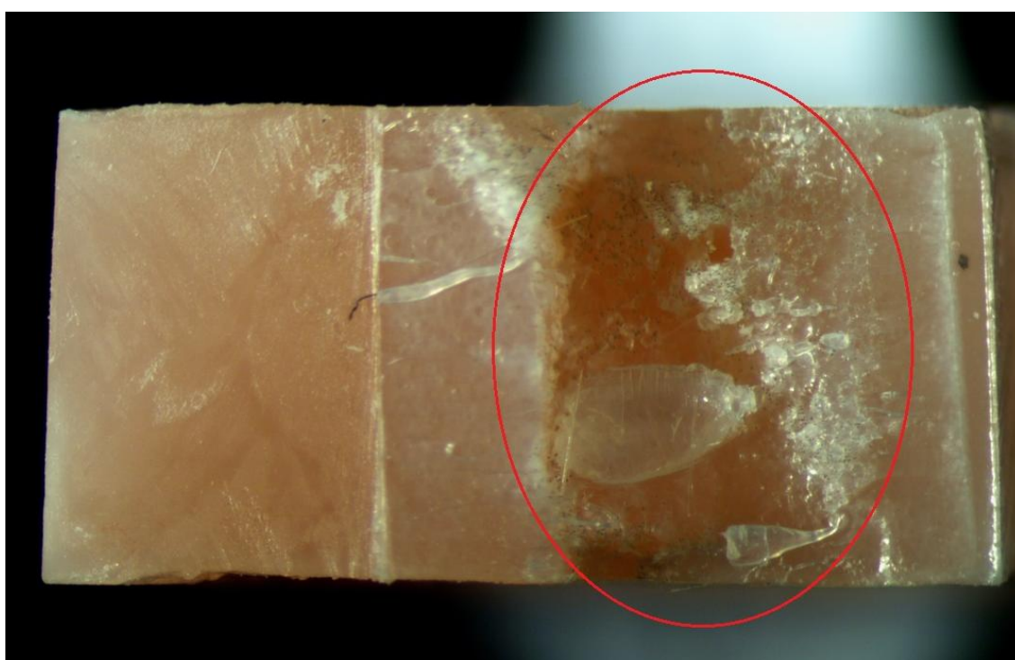
Kuva 25. Selacryl Impla. Kuivasäilytetty kuituvahvistettu testikappale. Mikroskooppikuva.
