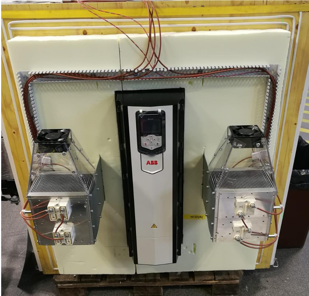
Kuva 14. Valmis kammiot toisistaan jakava välisenä sekä 2-kammion lämmityselementit.
