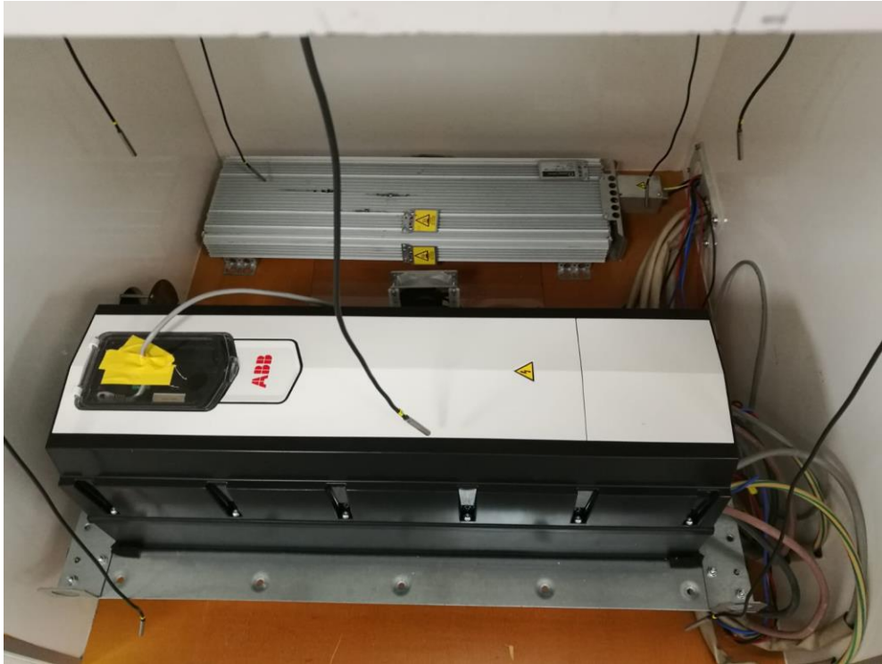
Kuva 17. Testattava laite alkuperäisen kalorimetrin sisällä koko laitteen kalorimetrin mittaus.
