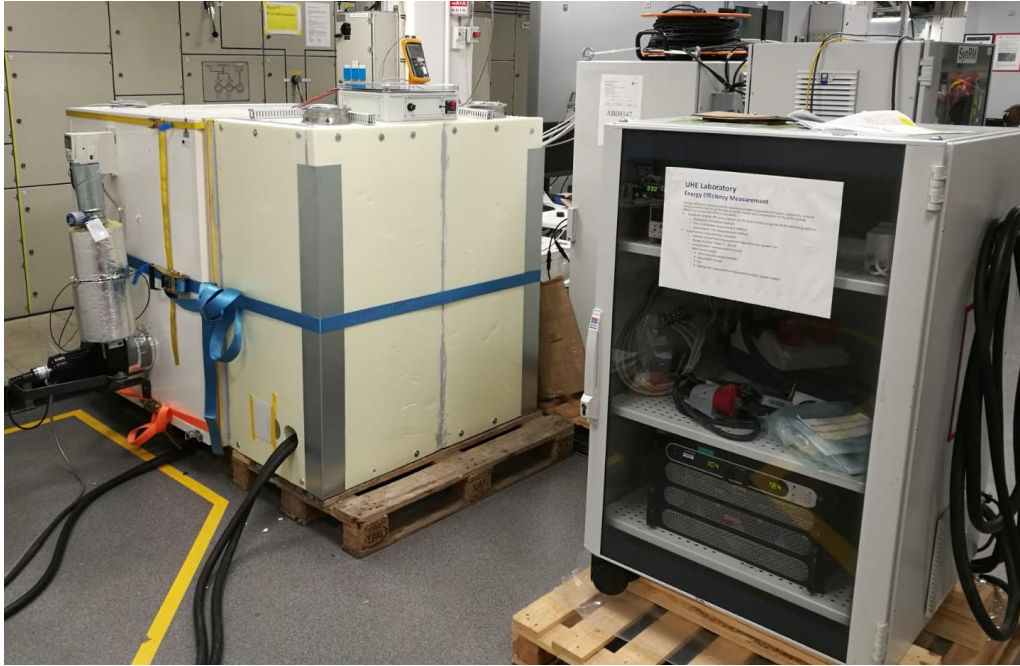
Kuva 16. Valmis kaksikammioinen kalorimetrinen mittausteisto.
