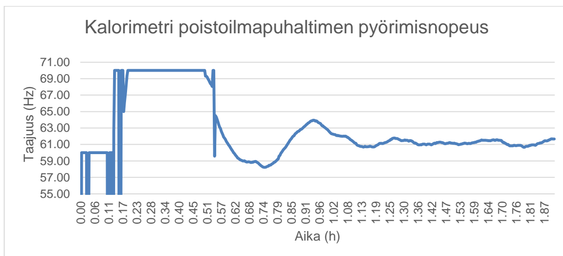
Kuvio 9. Tehopuolen kalibroitimittaus poistoilmapuhaltimen pyörimisnopeus hertseinä.
