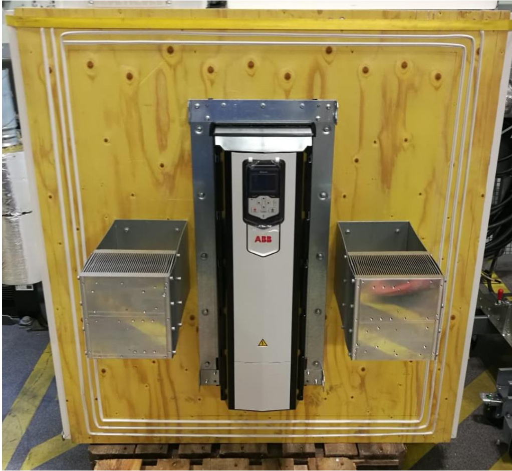
Kuva 12. Testattava laite sekä jäähdytyslementtien kiinnitys vanerilevyyn kammioiden välissä.
