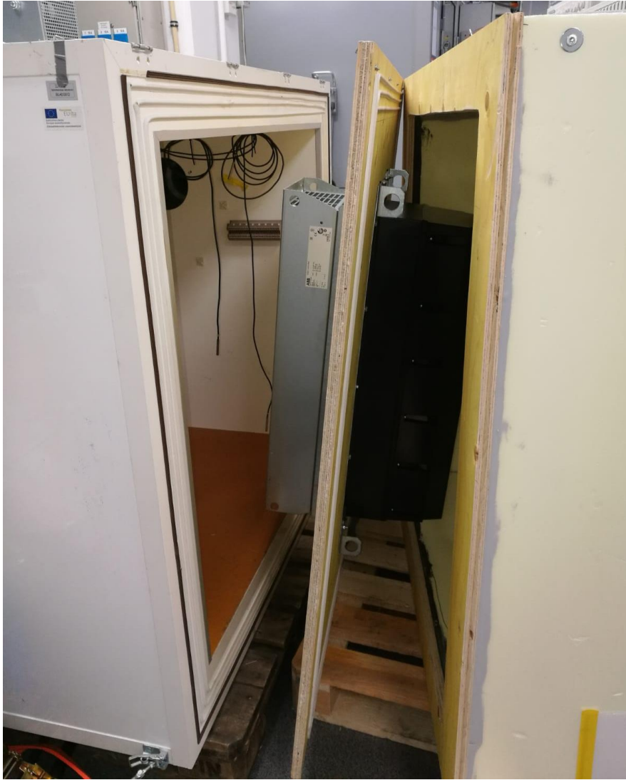
Kuva 11. Testilaitteen asennus kalorimetrin ja 2-kammion väliin.
