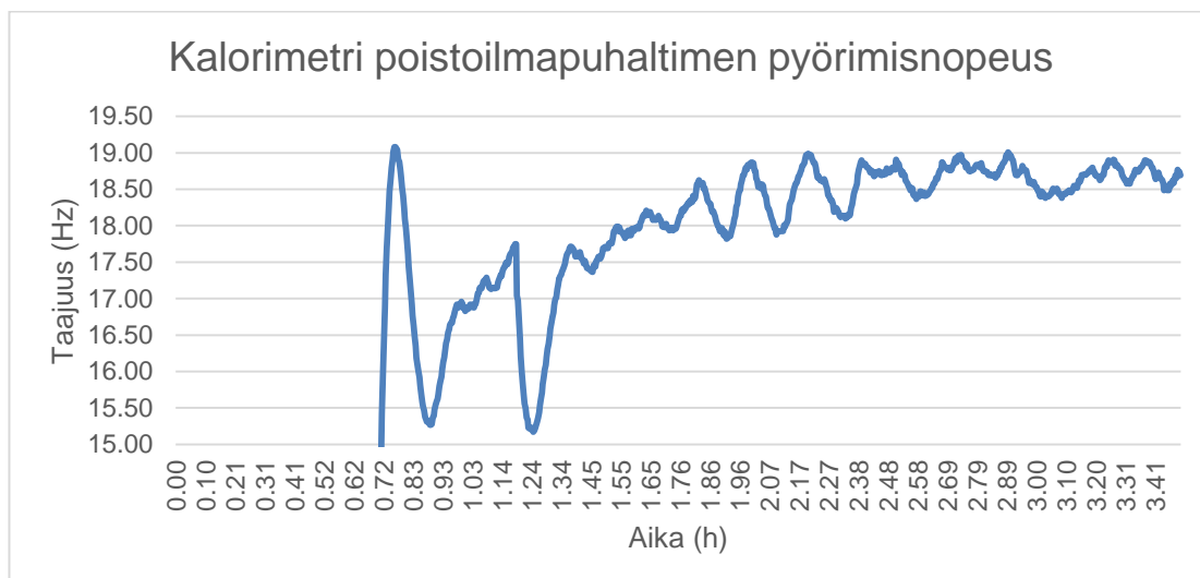
Kuvio 3. Ohjauspuolen kalibroitimittaus kalorimetrin poistoilmapuhaltimen pyörimisnopeus.
