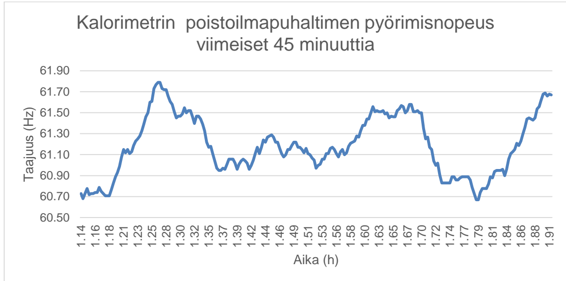
Kuvio 10. Tehopuolen kalibrointimittaus poistoilmapuhaltimen pyörimisnopeus hertseinä.
