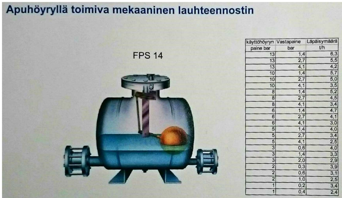
Kuvio 29. Konwell FPS 14-lauhteennostimen rakenne ja läpäisymäärätaulukko (Yleiskurssi n.d, 71.)
