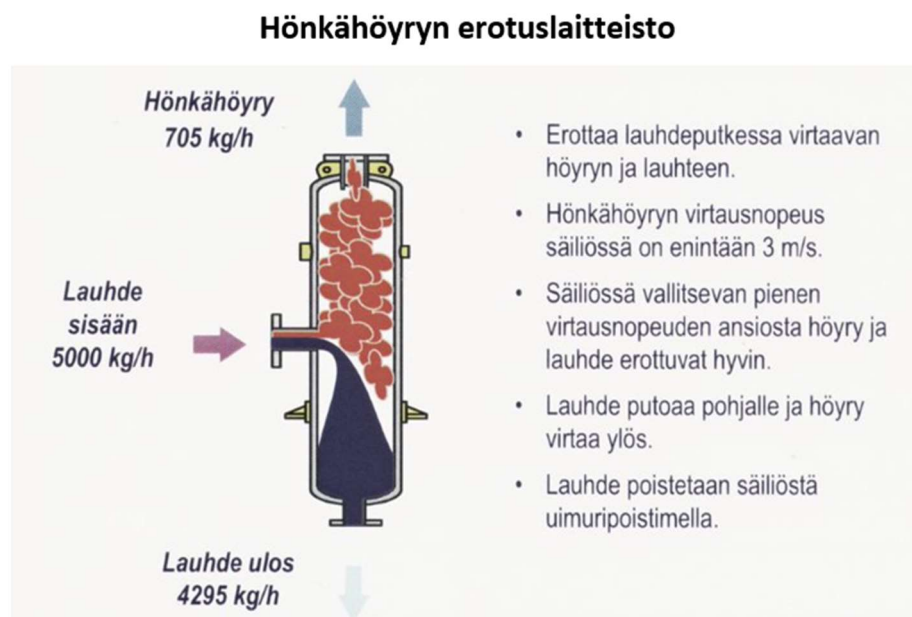
Kuvio 3. Hönkähöyry säiliöllä erotetaan kaksifaasivirtauksesta lauhde (Höyry- ja lauhdejärjestelmäkoulutus n.d, 159)
