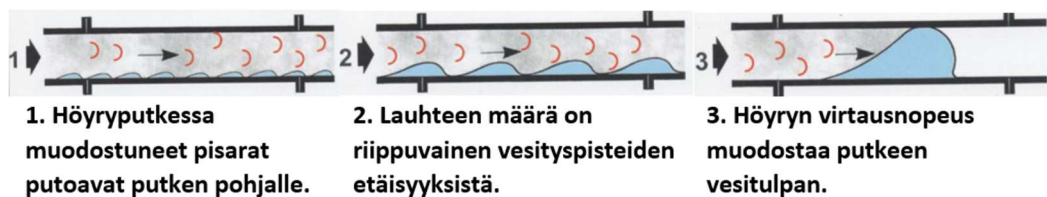
Kuvio 1. Vesitulpan kehittyminen höyryputkessa (Höyry- ja lauhdejärjestelmäkoulutus n.d, 62, muokattu)
