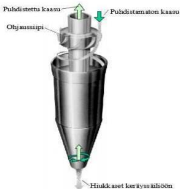
KUVA 5. Syklonierottimen toimintaperiaate (Visakova, 2015)
