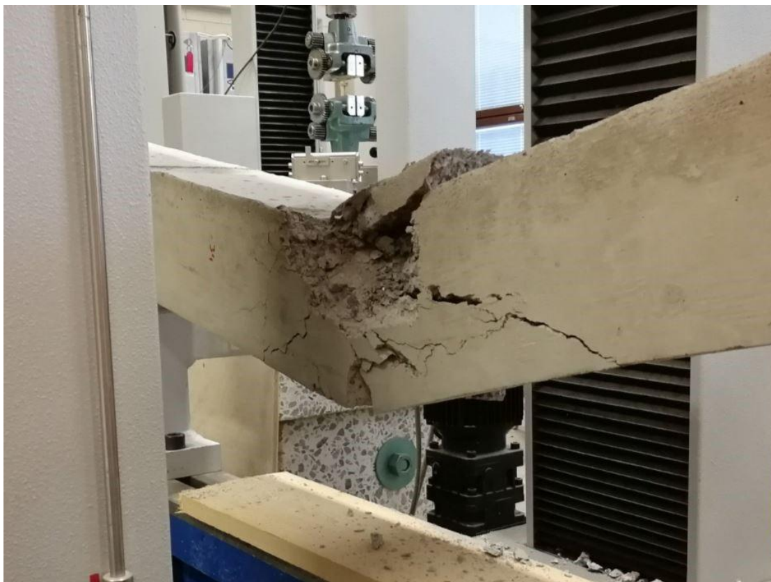
Kuva 9. Kuormitettu betonipalkki rakennustekniikan laboraatiossa.
