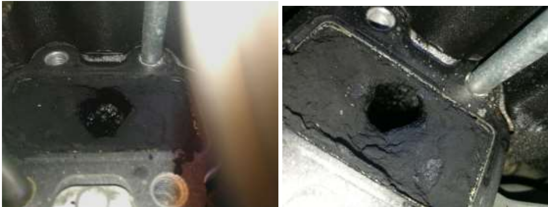
KUVA 17. Imusarjan EGR -kanava ennen puhdistusta (vas.) ja sen jälkeen
