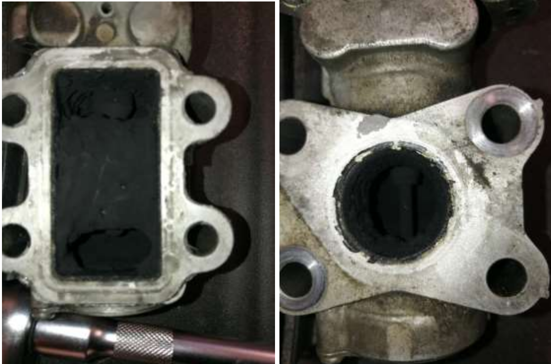
KUVA 22. EGR-venttiili kaksi viikkoa puhdistuksen jälkeen
