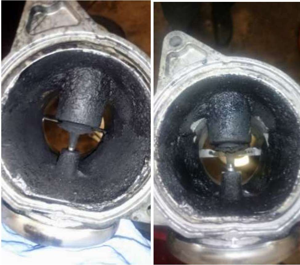
KUVA 35. Vasemmassa kuvassa EGR-venttiili ennen, ja oikealla ensimmäisen puhdistuskerran jälkeen.
