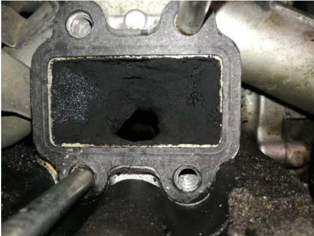
KUVA 20. EGR -kanava imusarjassa kaksi viikkoa puhdistuksen jälkeen
