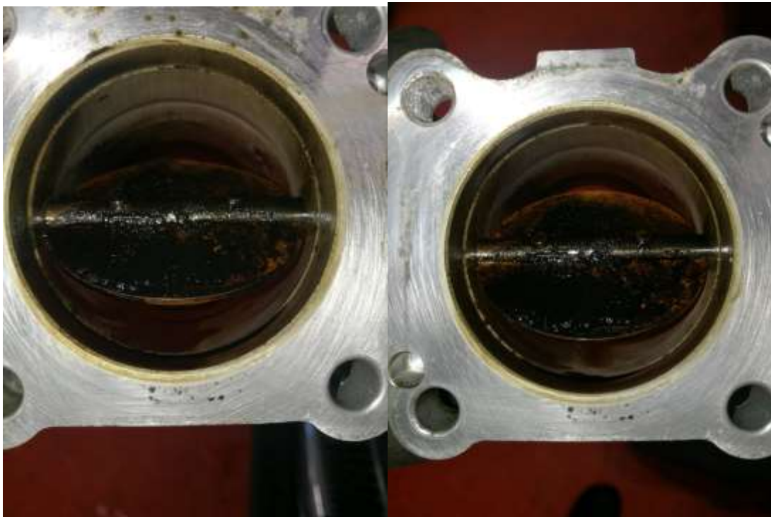
KUVA 19. Kaasuläppä ennen puhdistusta (vas.) ja sen jälkeen
