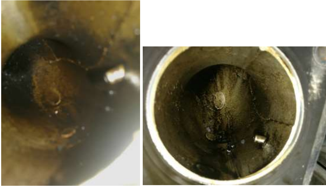
KUVA 18. Imusarja kaasuläpän takaa ennen puhdistusta (vas.) ja sen jälkeen
