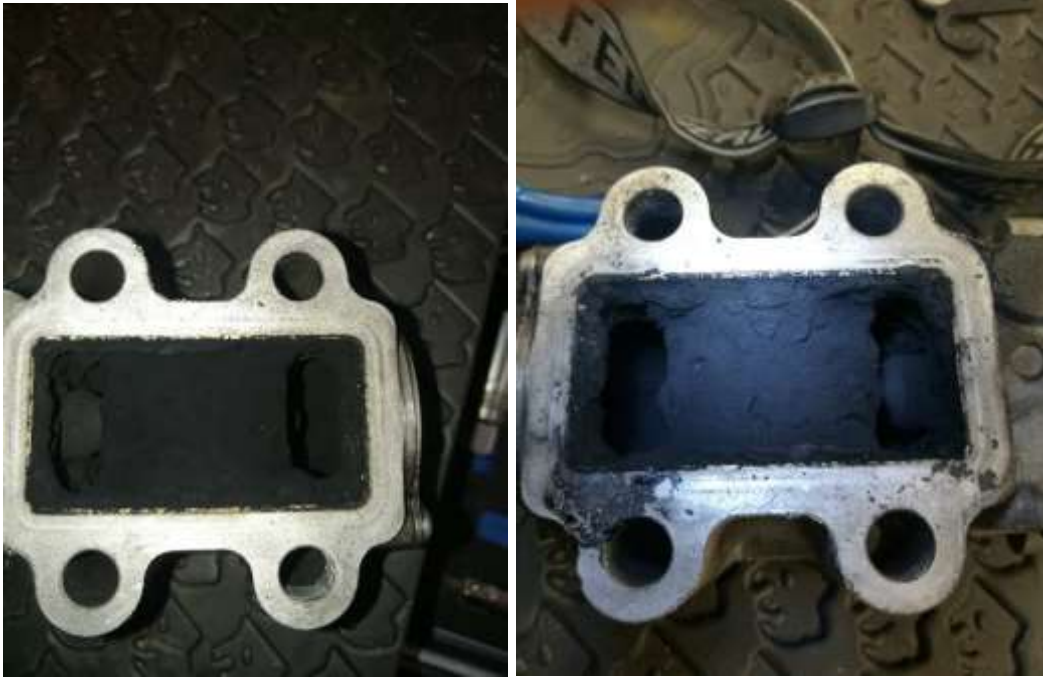
KUVA 16. EGR-venttiilin imusarjan puoli ennen puhdistusta (vas.) ja sen jälkeen
