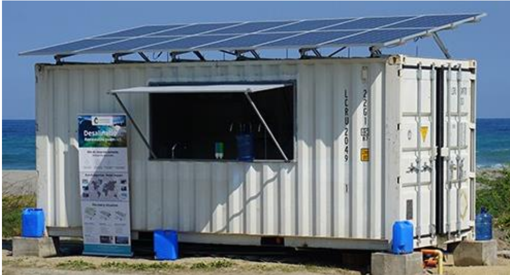
Kuva 17. Elemental Water Makersin Plug & Play -konttijärjestelmä [41].
