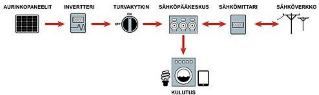
Kuva 5. Verkkoon kytketyn aurinkosähköjärjestelmän komponentit [12].
