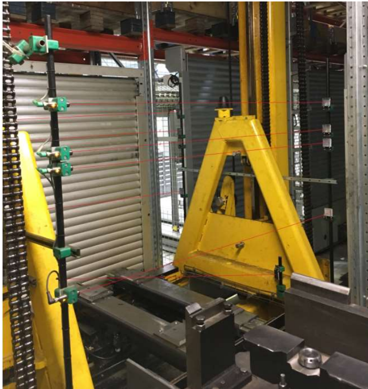
Kuva 17. Automaattihississä optisilla antureilla varmistetaan, että kappale siirtyy oikeaan kohtaan, eikä ole ulkona hissistä sen liikkuesssa. Punaisilla viivoilla on havainnollistettu optisten anturien valonsäteitä.
