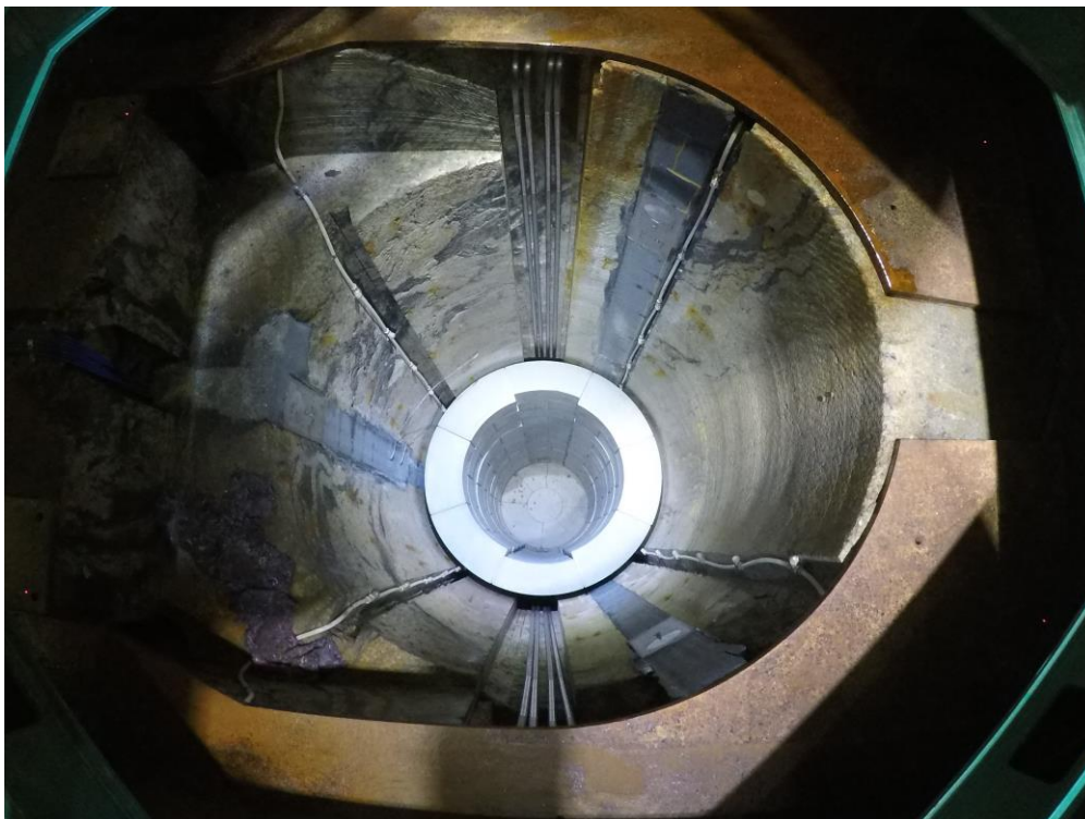
Kuva 6. Bentoniittipuskuri. Posiva Oy. (Kuva: Risto-Matti Meriniemi, 2018.)
