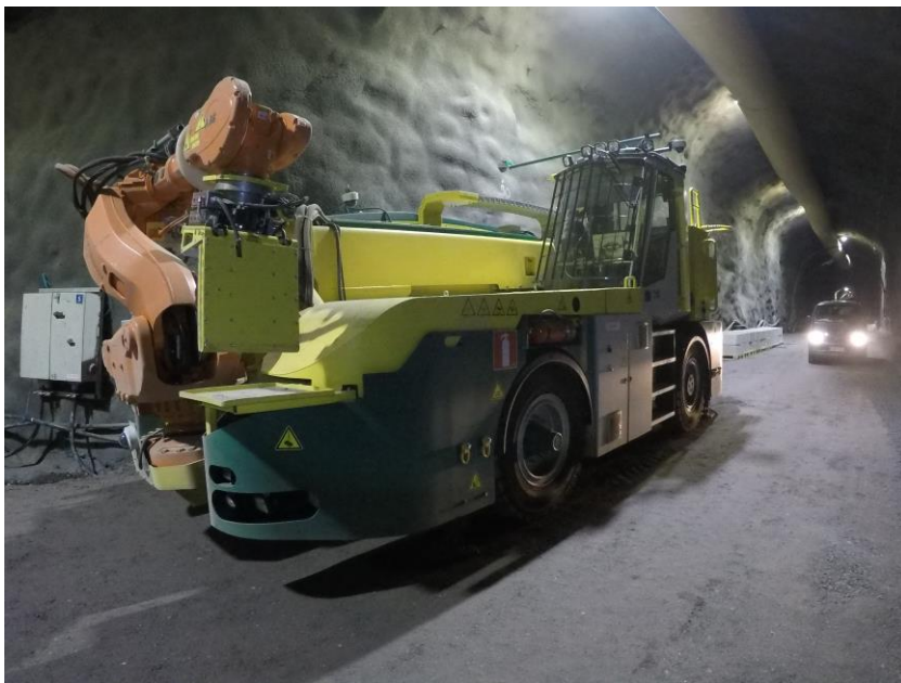
Kuva 11. Täyttömateriaalin asennusajoneuvo. Posiva Oy. (Kuva: Risto-Matti Meriniemi, 2018.)
