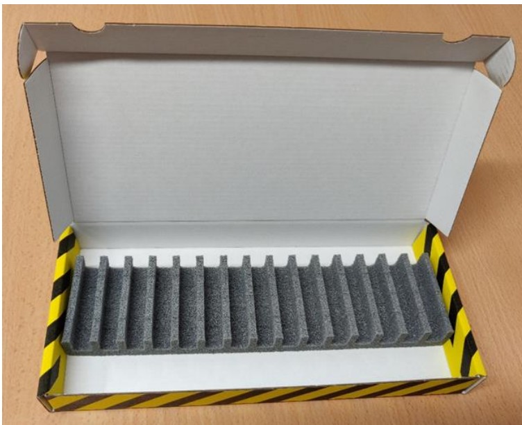
KUVA 3. Maksimissaan 15 potilasnäytteelle tarkoitettu ulkopakkaus ja sekundaaripakkauksen sisään tuleva näyteputket erotteleva vaahtomuovi
