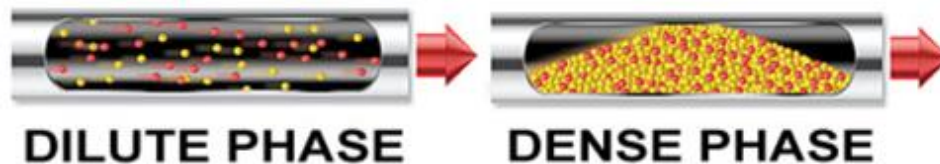
Kuva 4. Oikealla puolella lentokuljetus ja vasemmalla puolella hidaskuljetus. [18]
