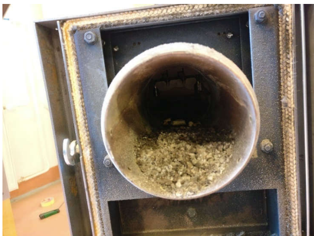
Kuva 18. Palotila puupelletin polttamisen jälkeen
