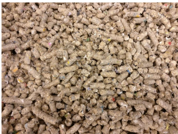
Kuva 29. 50 % SRF:ää / 50 % kierrätyspuuta sisältävää seospellettiä
