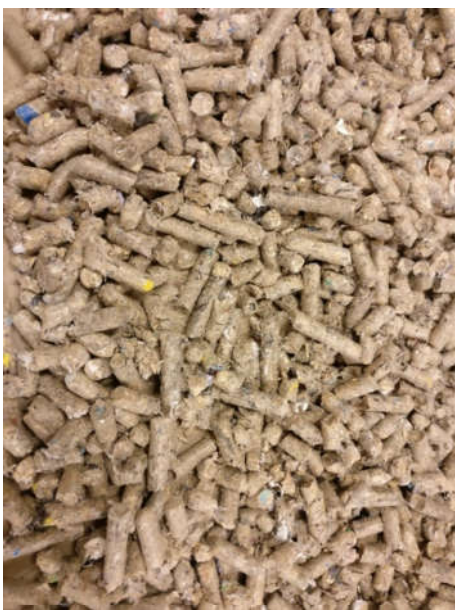
Kuva 23. 25 % SRF:ää / 75 % kierrätyspuuta sisältävää seospellettiä
