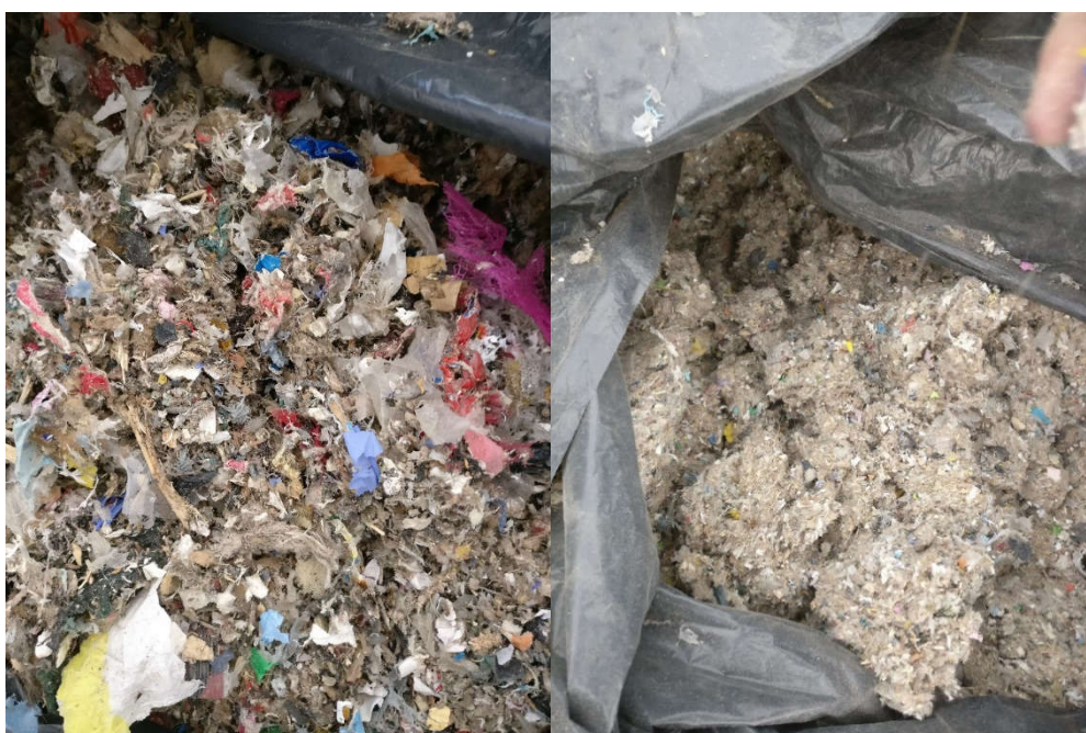
Kuva 5. Vasemmalla SRF:ää hienomurskaimen läpi ajettuna ja oikealla vielä lisäksi vasaramyllyllä hienonnettua
