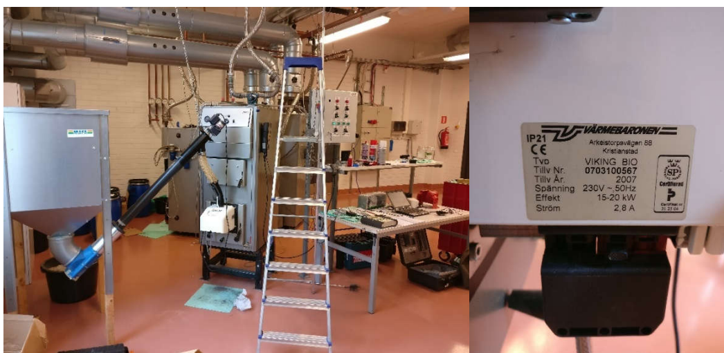
Kuva 13. Vasemmalla Energon Oy:n pienen polttinlaboratorion laitteisto, jolla koe suoritetaan ja oikealla lähikuva polttimen tiedoista
