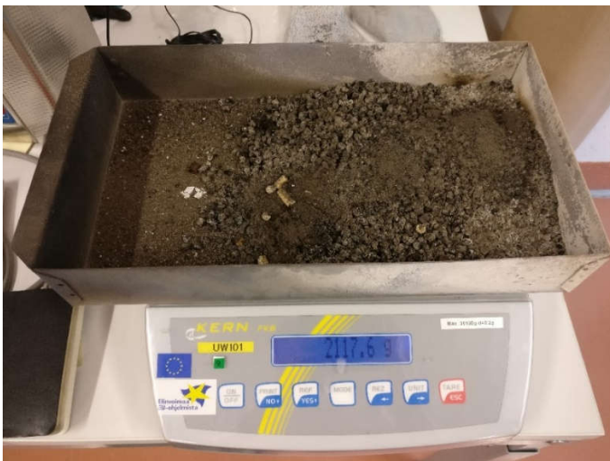
Kuva 36. Tuhka-astian painon mittaaminen
