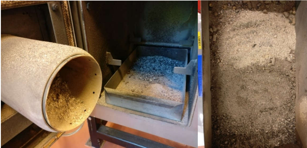
Kuva 32. Vasemmalla palotila polttamisen jälkeen ja oikealla lähikuva tuhka-astiasta
