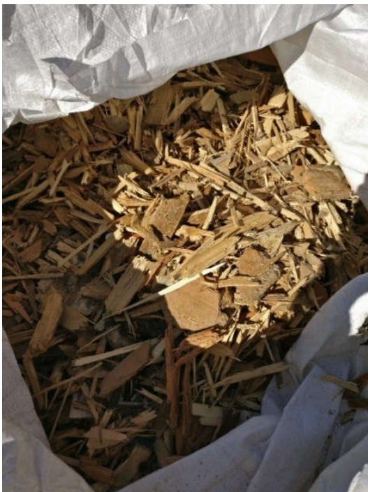
Kuva 1. Kierrätyspuuta pelkän PHJ:n murskaimen läpi ajettuna
