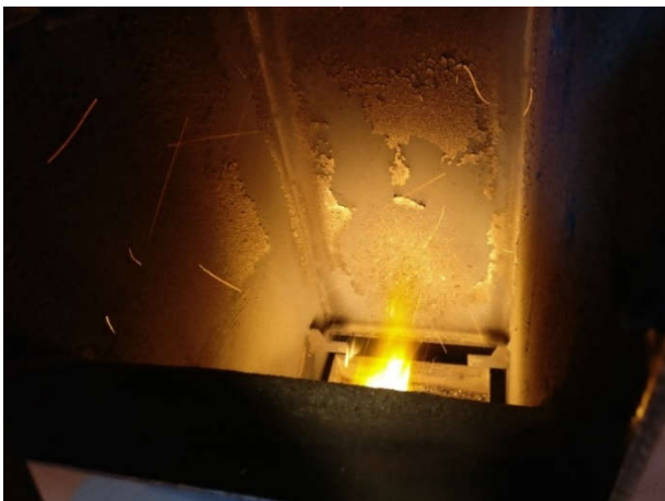
Kuva 27. 25 % SRF / 75 % kierrätyspuu-pelletti paloi parhaimmillaan erinomaisesti
