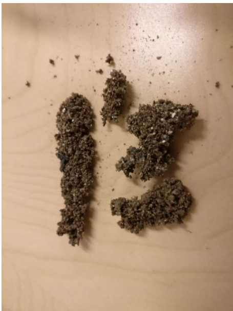
Kuva 22. Tuhkan seasta löytynyttä sintraantunutta tuhkaa
