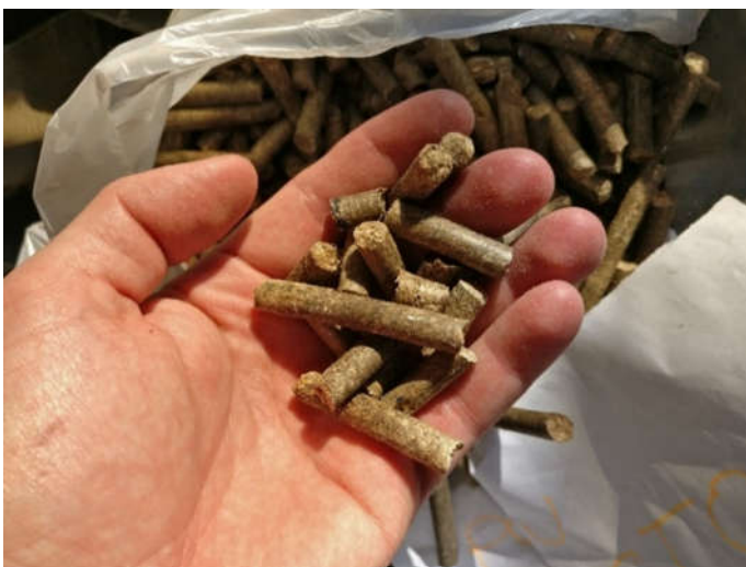
Kuva 12. Pelkkää kierrätyspuuta sisältäviä pellettejä
