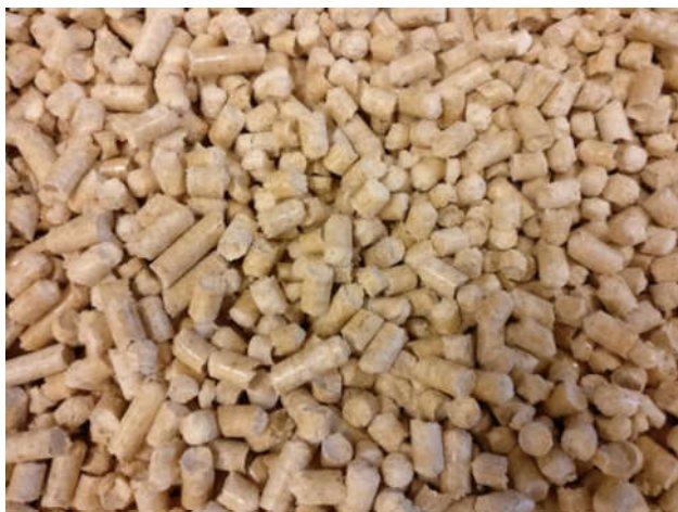
Kuva 16. Versowood Hotti -puupellettiä, jota käytettiin verrokipellettinä
