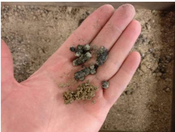
Kuva 28. Tuhkan seassa ollutta sintrausta ja palamattomia pellettejä
