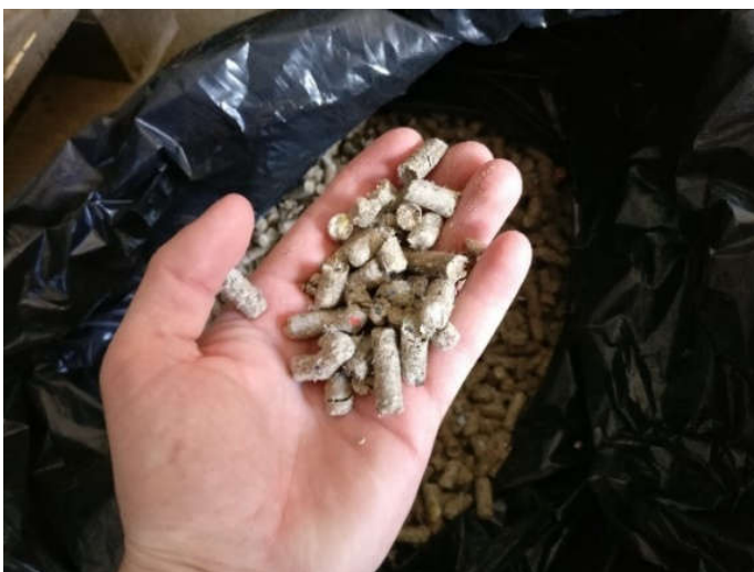
Kuva 11. 25 % SRF:ää / 75 % kierrätyspuuta sisältäviä pellettejä
