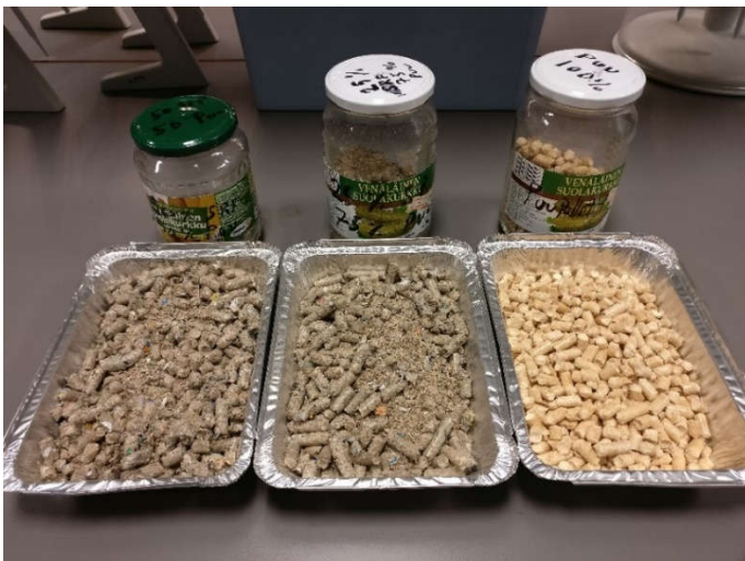
Kuva 34. 50 % SRF:ää / 50 % kierrätyspuuta, 25 % SRF:ää / 75 % kierrätyspuuta ja kaupallinen puupelletti menossa lämpökaappiin kuivumaan
