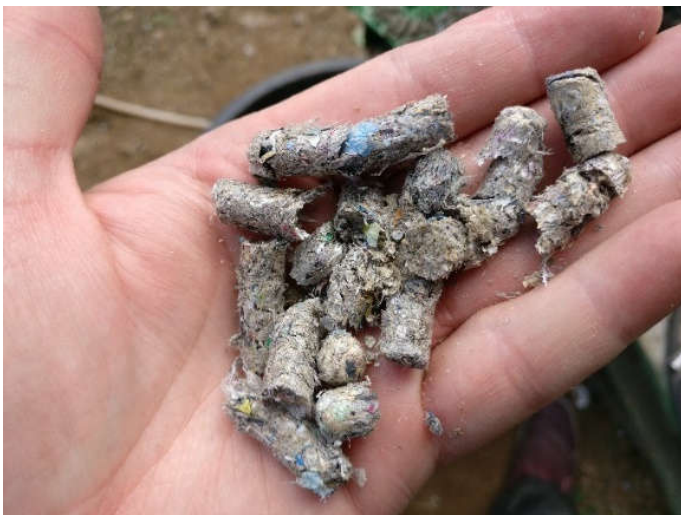
Kuva 10. 50 % SRF:ää / 50 % kierrätyspuuta sisältäviä pellettejä
