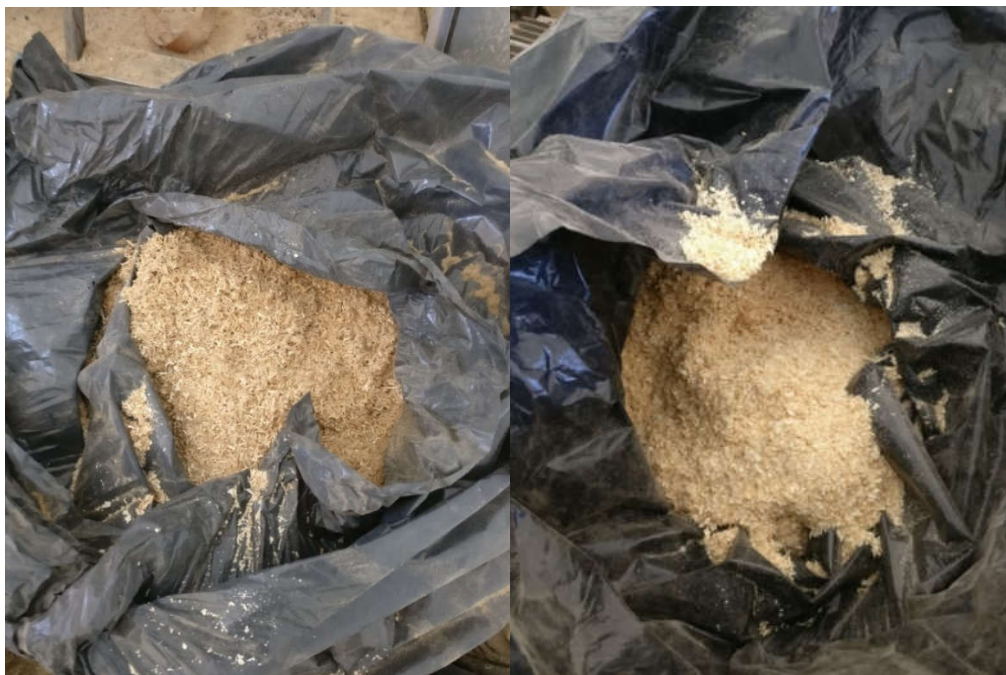
Kuva 4. Vasemmalla kierrätyspuuta vasaramyllyn läpi ajettuna ja oikealla tuoretta purua SRF:lle tehtiin samat esikäsittelytoimenpiteet, eli ajettiin murskaimella pienemmäksi ja sen jälkeen hienonnettiin vasaramyllyllä (kuva 5). Vasaramyllyllä hienonnettu SRF on hyvin huokoista ainetta, aivan kuin pumpulia. Materiaalissa voisi olla potentiaalia lämmöneristeeksi.
