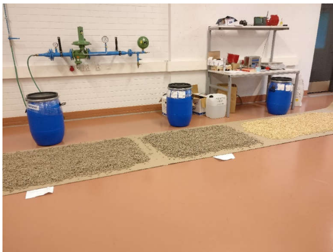
Kuva 33. Jakeet levitettiin Energon Oy:n pienen polttinlaboratorion lattialle pariksi päiväksi, jotta kosteus tasaantuisi tasaiseksi
