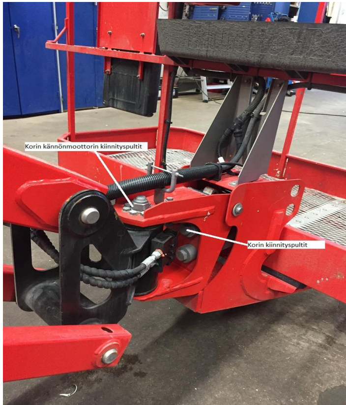
Kuva 4. Korin kääntömoottori sekä korin kiinnitys.
