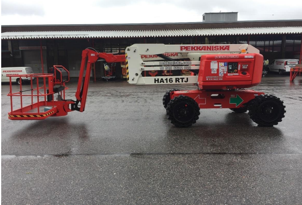
Kuva 1. Haulotte 16RTJ, nivelletyllä puomilla oleva kuukulkija.
