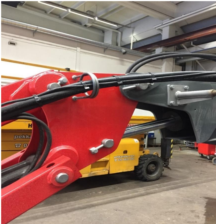
Kuva 3. Puominostimen puomin hydraulisynterin kiinnitys.
