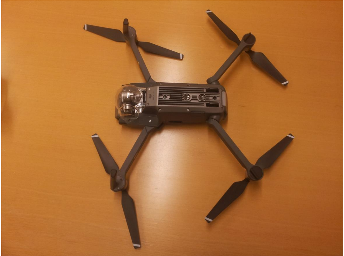
Kuva 13. DJI Mavic Pro ylösalaisin, nuoli osoittaa korkeudentunnistukseen käytettävät ultraäänisensorit. (Kuva: Teemu Siponen).
