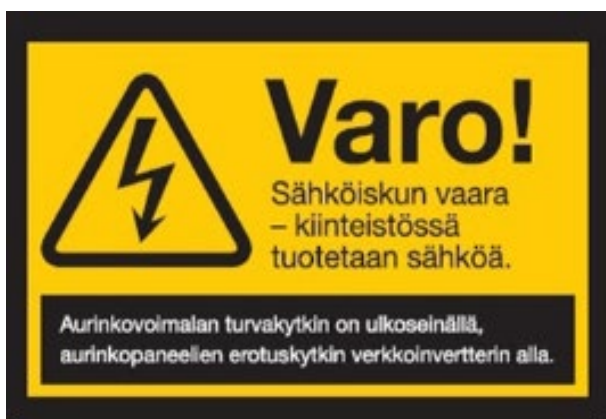
Kuva 11. Aurinkosähköjärjestelmästä varoittava kyltti (Kauko Store www-sivut 2019).
