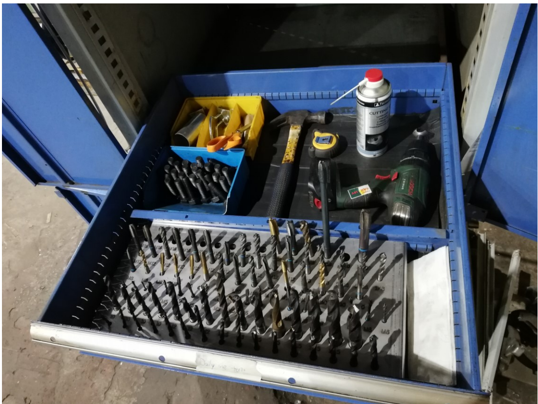
Kuva 13. 5S-käyttöönoton jälkeen viikkotasolla tarvittujen työkalujen uusi säilömisjärjestelmä
