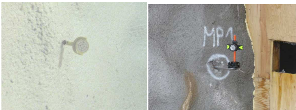
Kuva 5. Vasemmanpuoleisessa kuvassa peilipiste ja oikeanpuoleisessa kuvassa putkipiste (10).
