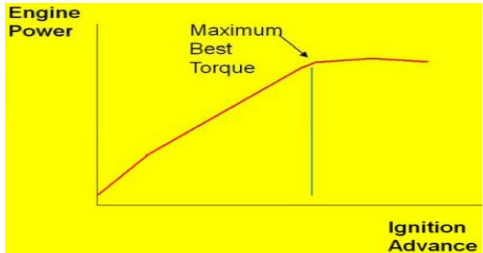
Kuva 22. MBT –pisteen sijainti sytytysennakon ja moottoritehon funktiona [20, s. 111]
