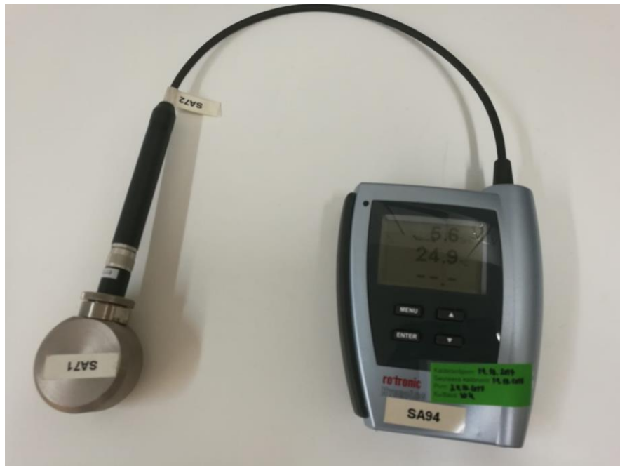
Kuva 4. Ilmankosteusloggeri yhdistettynä kalibrointikammioon
