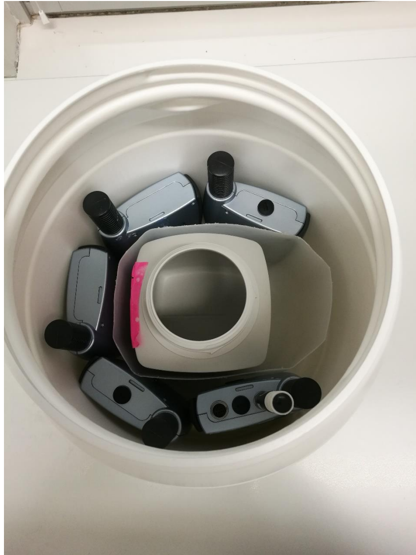
Kuva 8. Menetelmän suunniteltu kalibrointiasetelma
