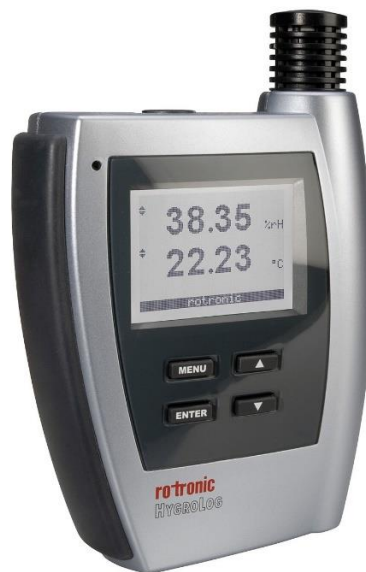
Kuva 2. Hygrolog - HL-NT2-D (Rotronic AG, 2018)
