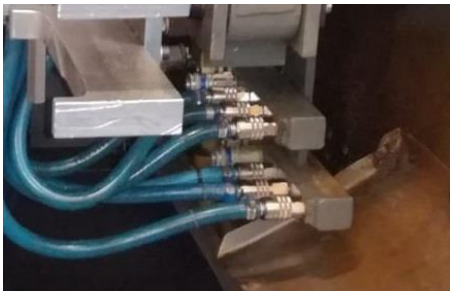
Kuva 11. Esimerkki erän koneen tiivisti pakatuista vesiletkuista muottiin.
