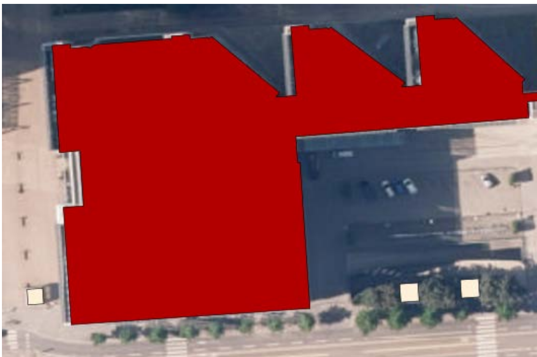
Kuva 12. Aurinkosähköpotentiaalin tarkastelu samaiseen kiinteistöön. (42.)
