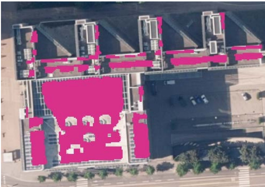
Kuva 11. Paneeleille sopivat asennuspaikat. (42.)
