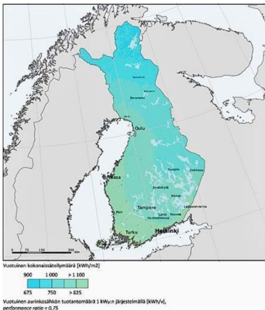
Kuva 5. Vuotuinen aurinkosähkön tuotantomäärä 1 kW p :n järjestelmällä (kWh/v) optimaalisesti suunnatuille ja kallistetuille pinoille. (15.)
