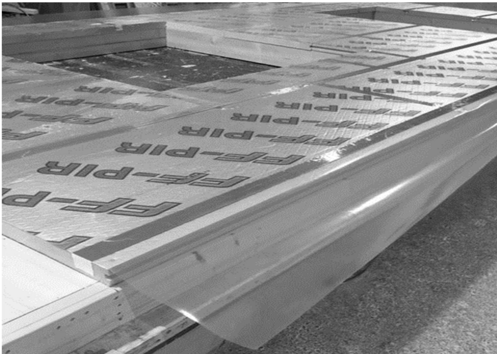
Kuva 32. Ulkoseinäelementin höyrynsulun limitysvaraus yläpohjan höyrynsulkuun.
