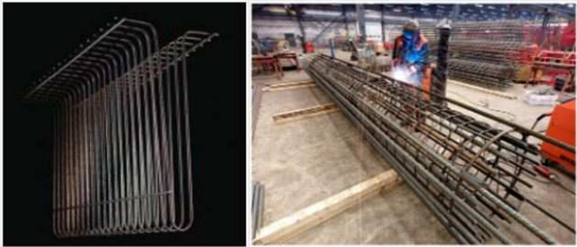
Kuva 6. Vasemmalla verkosta taivutettu R-tyyppin komponentti, oikealla hitsattu paalupilarikomponentti
