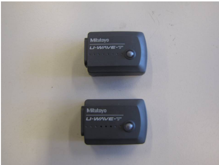
Kuva 2. U-WAVE-T lähettimet. Kuvassa ylempi on nestesuojattu ja alempi toimii myös äänimerkillä.
