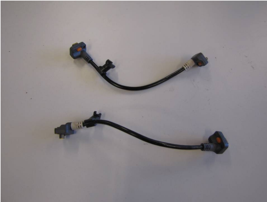
Kuva 5. Lyhyet kaapelit. Ylempi kaapeli kuvassa on suorapäinen, alemmassa toinen pää on 90° kulmassa.
