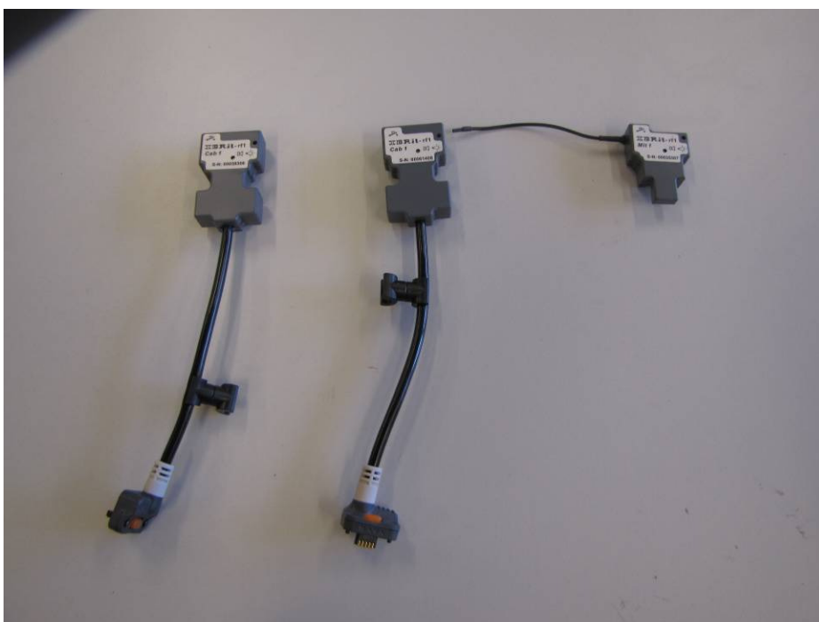
Kuva 8. Vas. IBRit-rf-cab1 lähetin Mitutoyon kaapelilla, jonka kiinnityspäässä 90° kulma. Kesk. IBRit-rf-cab1-lähetin Mitutoyon kaapelilla, jossa on suora pää ja oik. IBRit-rf1-mit1-lähetin, joka kiinnitetään suoraan mittauslaitteeseen.
