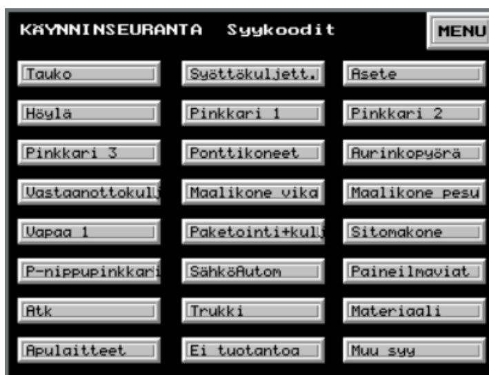
KUVIO 21. Uuden höylälinjaston uusittu käynninseurantapaneeli
