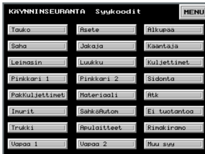
KUVIO 27. Vannesahalinjaston uusittu käynninseurantapaneeli
