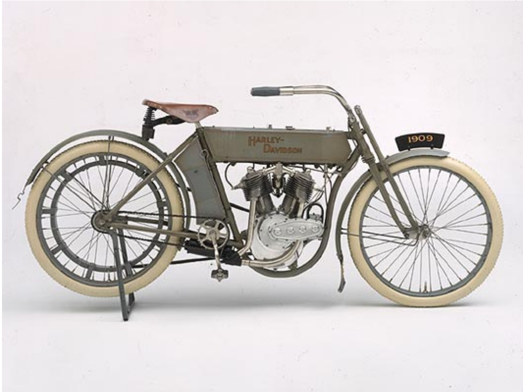
Kuva 1. 1909 mallin Harley-Davidson V2-moottorilla /2/
