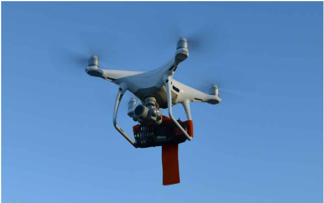
Kuva 7. Mittarin kiinnitys lennokkiin ensimmäisen koelennätysten aikana.
