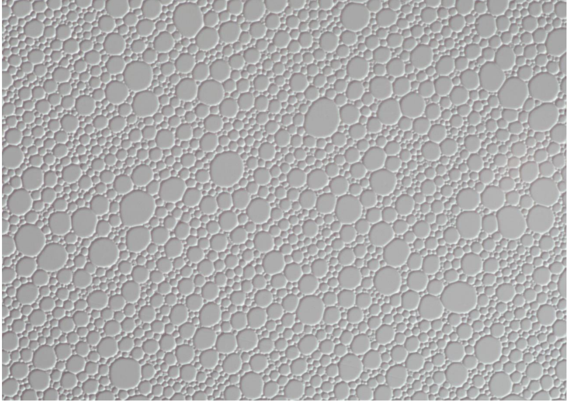
Kuva 3. Mikroskooppikuva emulsion matriisista. Kuplan läpimitta on keskimäärin 1 mikrometri. (Dibley 2018.)
