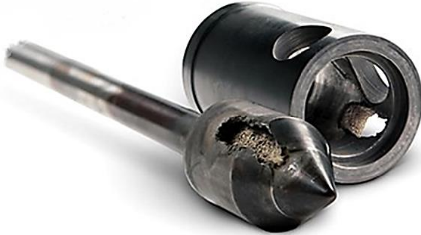
Kuva 17. Kavitaatioeroosion aiheuttama kuluminen (Evans & Ritter 2015).
