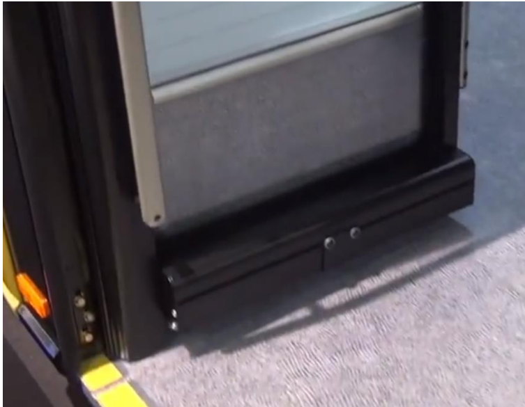
KUVA 24. Venturan alatiivistysratkaisu (Solaris Urbino 12, Youtube 2019)
