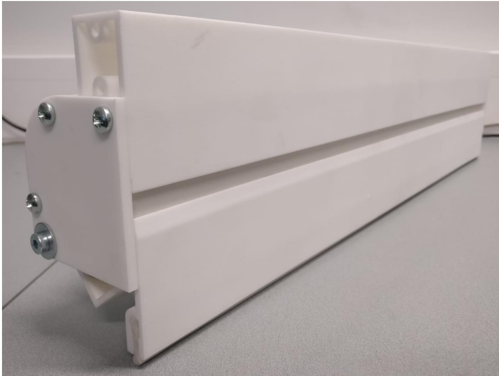
KUVA 18. Prototyypin profilit ja päätylevyt 3D-tulostettiin (Poutanen 2019)
