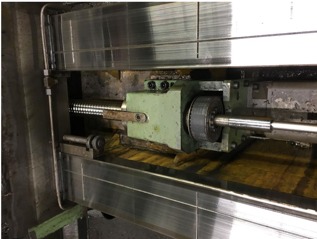
Kuva 3. Fill jyrsinkoneen johdevoitelun urat johteissa.
