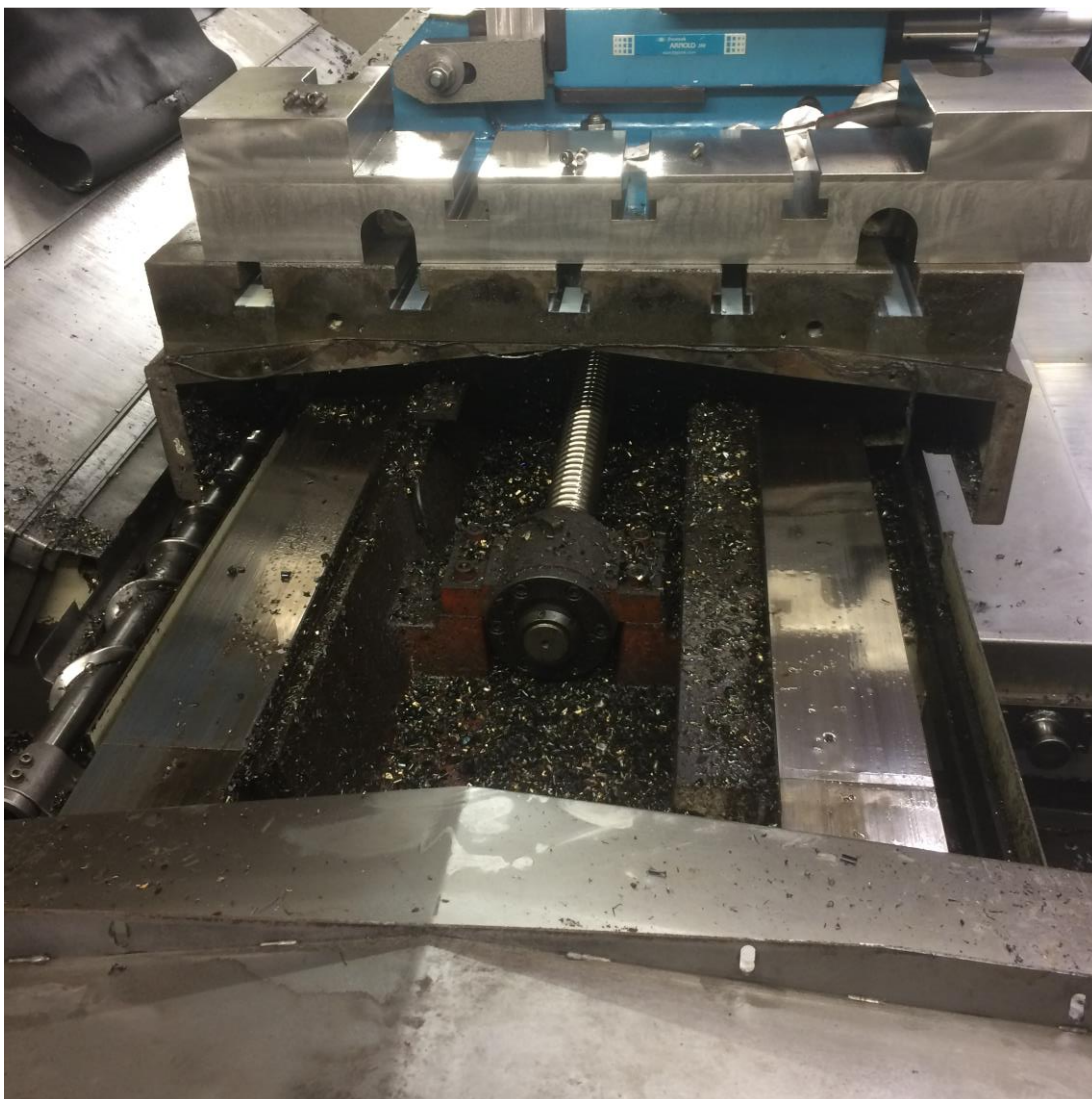
Kuva 1. Jysinlastuja on kerääntynyt runko- ja johdepinnoille.
