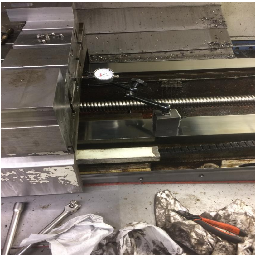
Kuva 2. Ristisyöttöpöydän kuularuuvien välyksen tarkastus.
