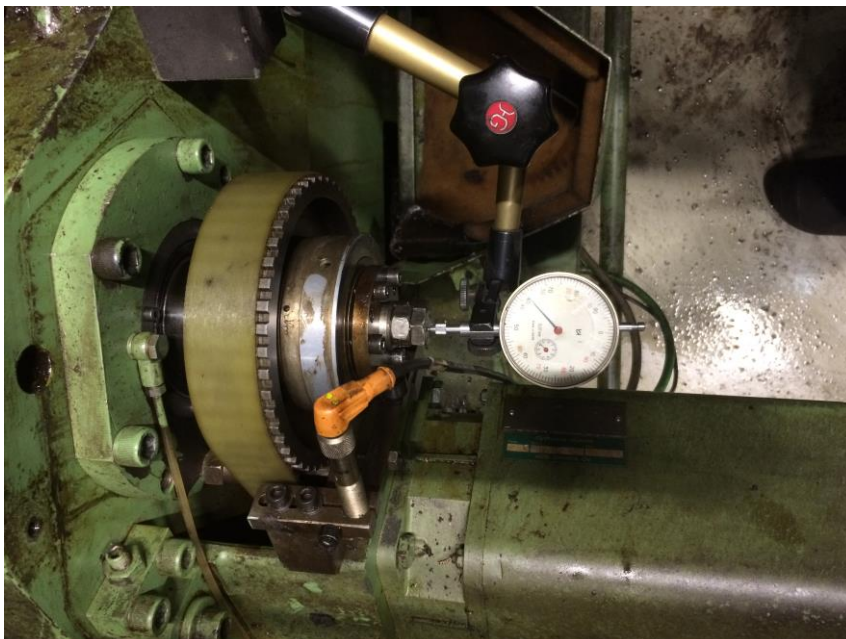
Kuva 7. Käyttömoottorin kuularuuvien päittäisvälyksen mittaus.
