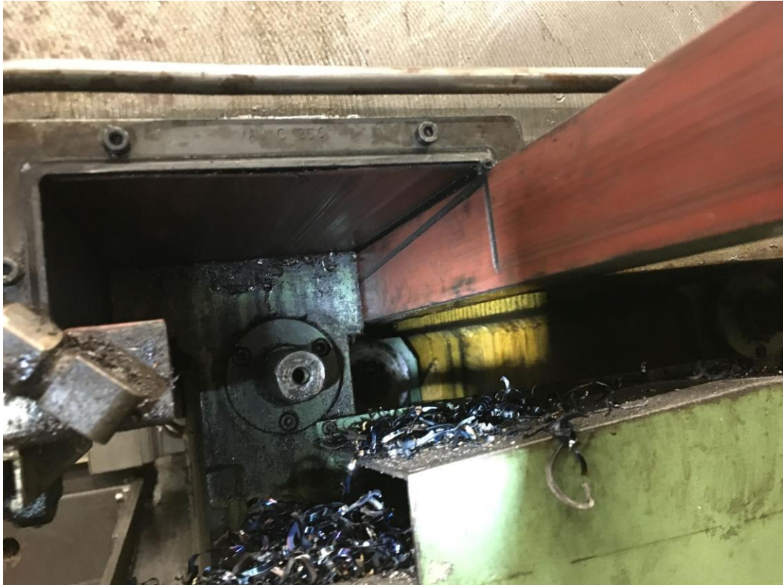
Kuva 4. Jyrsinpöydän liikealue on pidempi kuin johdepinnat.
