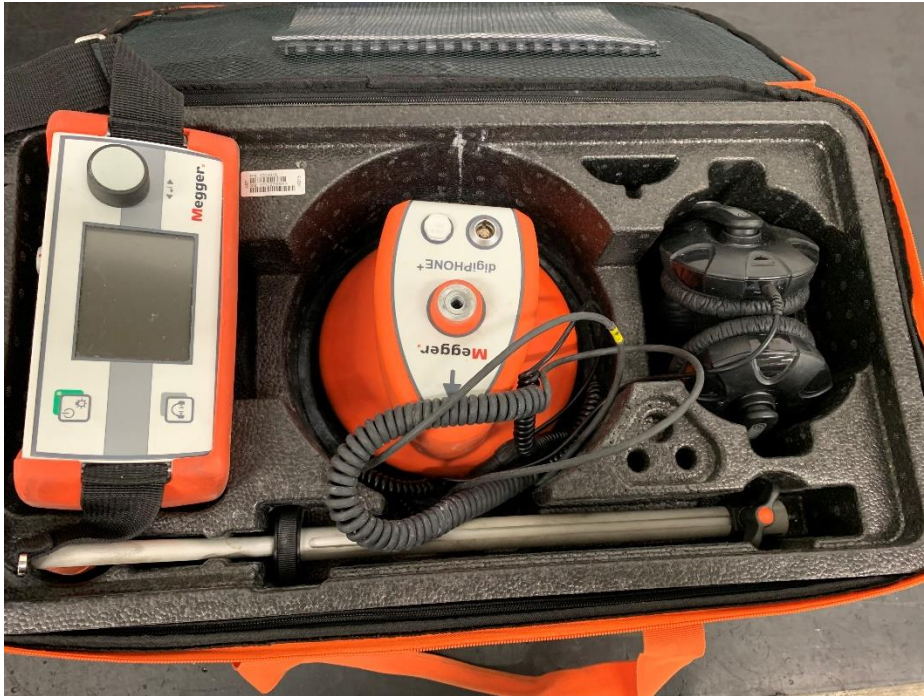
Kuva 8. Meggerin maamikrofoni ja kuuntelulaite, jotka ovat käytössä Kemin Energiassa ja Vedellä
