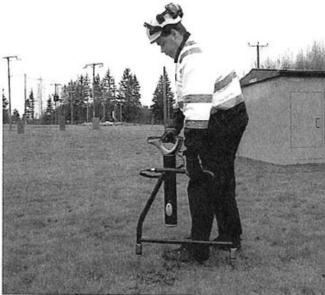
Kuva 10. Vaippavian etsintähaarukka käytössä. (Monni 2015, 119)
