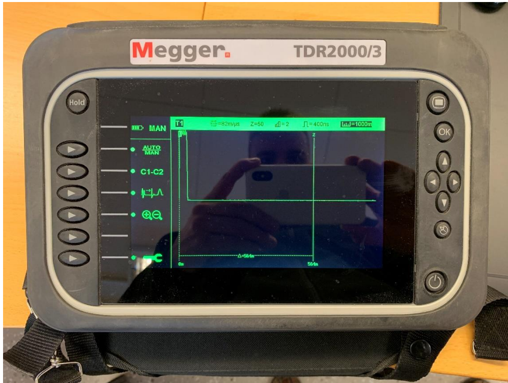
Kuva 9. Meggerin TDR-tutka 2000/3, joka on käytössä Kemin Energialla ja Vedellä.
