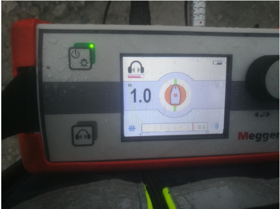
Kuva 16. Meggerin kuuntelulaite ja etäisyys suorasta vikapaikasta vasemmalla kuvaruudussa.
