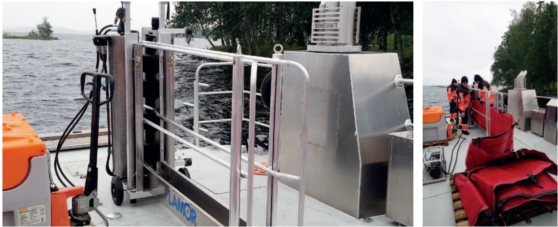
Kuva 40. Puominostoon on käytettävissä myös apuvälineitä, kuten tämä Kymenlaakson pelastuslaitoksella suunniteltu puominnostolaite (Halonen 2017).
