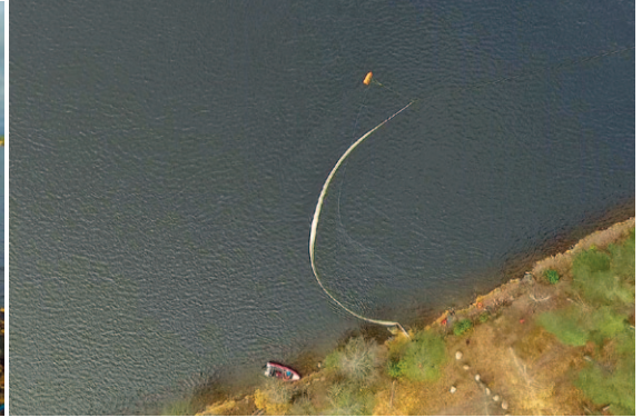
Kuva 29. Paravaani-puomitus, sama tilanne rannalta ja ilmasta katsottuna. Puomituksen muoto on huomattavasti helpompi hahmottaa ilmakuvasta. RPAS-kuvan perusteella havaittiin puomin jääneen liikaa pussittamaan. Tilanne korjattiin siirtämällä puomin rantakiinnityspistettä kauemmas alavirtaan. (Rantavuo 2017 ja Pitkäaho 2017)
