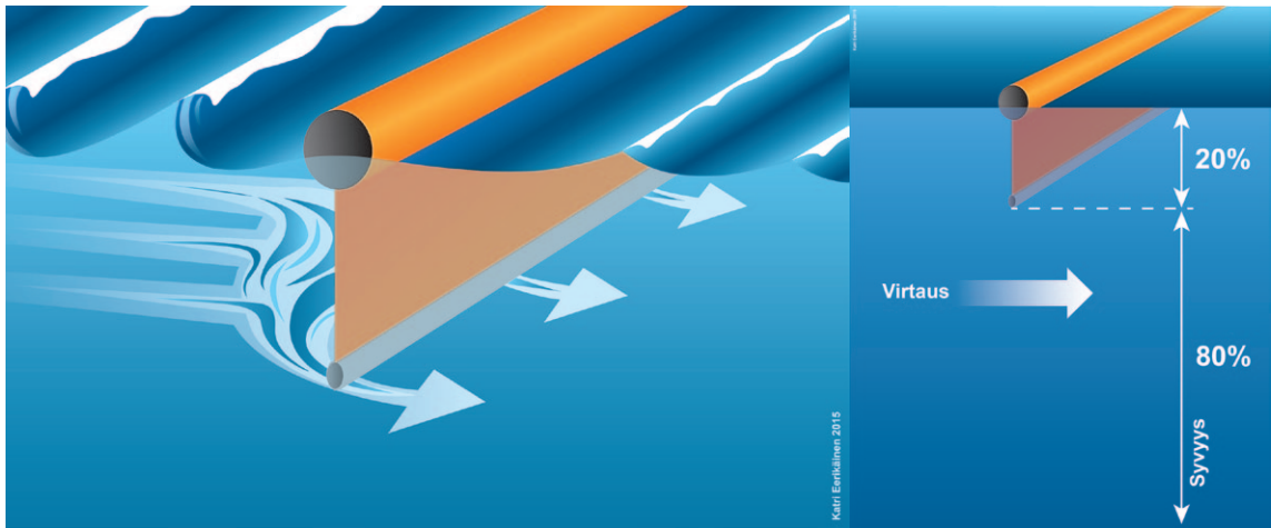
Kuva 21. Jos puomi plokkaa veden syvyydestä yli 20 %, kasvaa puomin alitse virtaavan veden nopeus suureksi saman vesimassan virratessa pienemmästä alasta.
