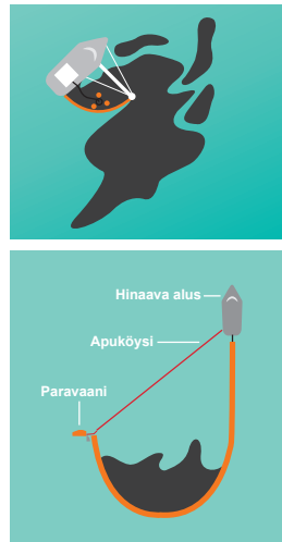
Kuva 19. Keräystä yhdellä aluksella laitakerääjän (ylemmässä) ja paravaanin avulla (alemmassa kuvassa). Keräysjärjestelmissä on tyypillisesti kiinteät keräimet, mutta puomin pohjukassa voidaan kuljettaa myös kelluvaa keräintä. (IPIECA-IOGP 2015)
