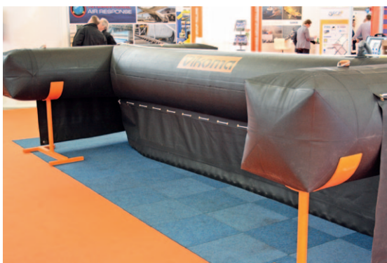
Kuva 4. Eri puomityyppejä. Vasemmalla pääasiassa aitapuomia erilaisilla kellukkeilla, oikealla verhopuomirakenteinen avomeripuomi. (Halonen 2015).
