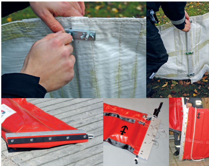
Kuva 2. Erilaisia puomiliittimiä. Ylä- tai alakautta liu'utettavan liuku-liitoksen ja Z-liitoksen lisäksi käytössä on mm. U-pulttiliitoksia aluslevyllä ja siipimuttereilla. U-pulttiliitos tulee kiinnittää valmiiksi ennen veteen laskua. Toisissa liitintyypeissä on uros- ja naaraspuolet puomin eri päissä, ja tämä tulee huomata liitettäessä useampaa puomijataa yhteen vedessä. (Halonen 2009, 2016 ja 2017)
