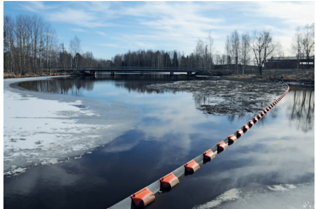
Kuva 9. Kiinteäkellukkeinen aitaapuomi (Pitkäaho 2017 ja Muhonen 2012).
