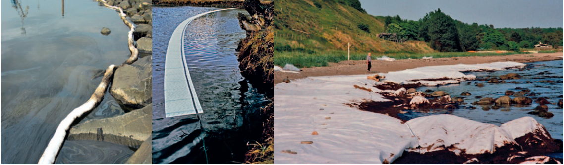
Kuva 34. Pitkomaisen imeytyspuomin suojausteho on melko heikko: pyörähdellessään pitko päästää öljyn altaan, sillä puomissa ei ole helmaa, joka estäisi öljyn leviämisen. Nauhapuomi säilyttää kosketuksensa veteen aallokossakin, ja sen imeytyspinta-ala on laaja. Rannansuojamaton suojausteho on hyvä, mikäli matto saadaan aseteltua kivikkoon tiiviisti. (Hintsala, Knorring Oy Ab 2014, Etelä-Karjalan pelastuslaitos ja Sydöstra Skånes Räddningstjänst 2006)
