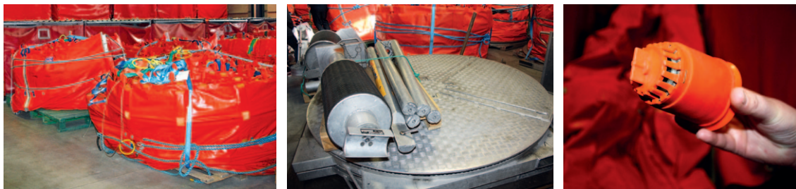
Kuva 7. Itsetäyttyvää Expandi-puomia. Valmistajan mukaan puomin vakavuus riittää vielä 15 m/s tuulella, 2 metrin aallokossa ja 3 solmun (1,5 m/s) virtauksessa. (Pitkääho 2017)
