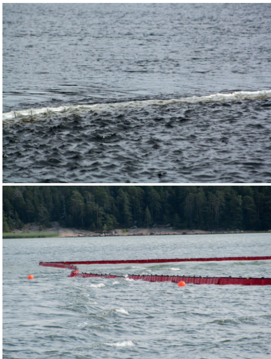
Kuva 23. Suurissa virtausnopeuksissa puomit tulee asettaa kulmaan vedenvirtaussuuntaan nähden, mikä vähentää puomiin kohdistuvaa suhteellista virtausnopeutta. Puomien toimintavarmuus saattaa heiketä myös aallokossa. (Halonen 2017 ja Pitkäaho 2017)
