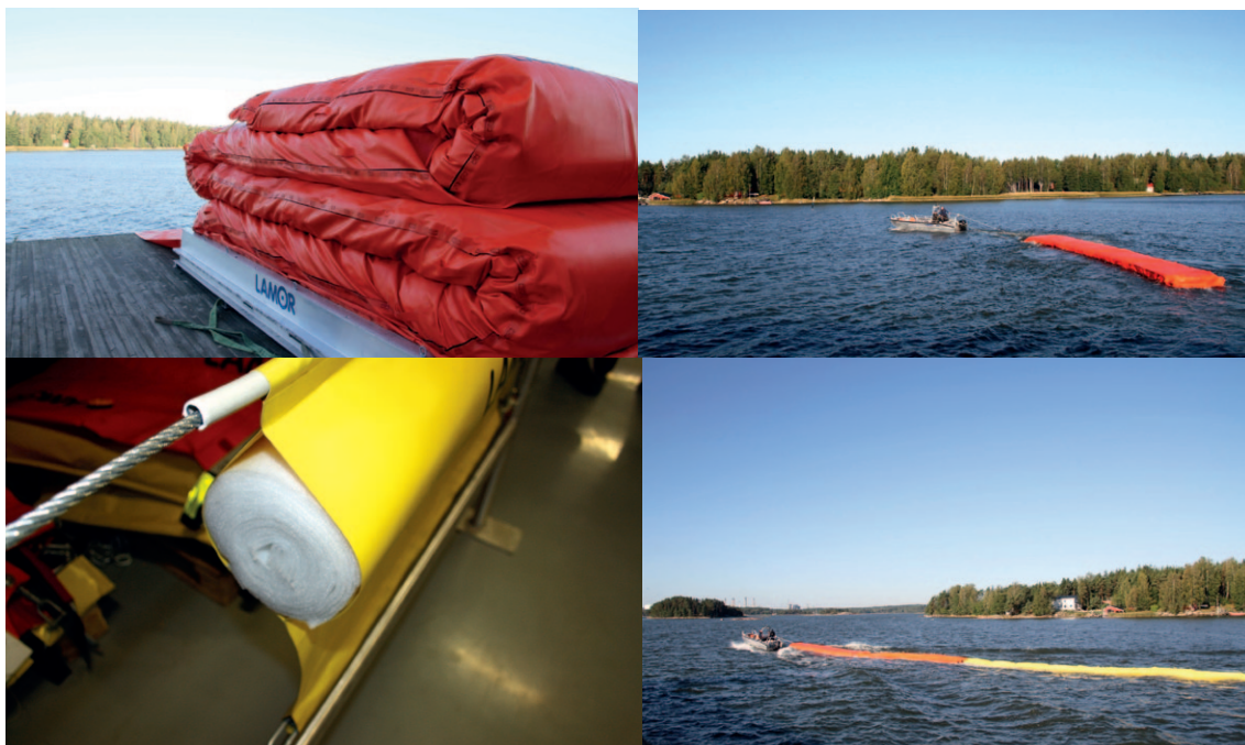
Kuva 8. Puomien nopeaa levittämistä varten on kehitetty erilaisia pikapuomitusjärjestelmiä. Kuvassa selvittää pikapuomia, jossa on taipuisa solumuovikelluke. (Lamor Corporation Ab ja Pitkääho 2017)
