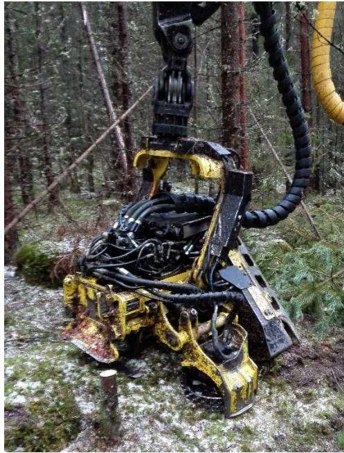
Kuva 5. Huoltotöinä voi olla esimerkiksi hakkuupään letkurikkojen korjaaminen. (Kauppinen, 2018)
